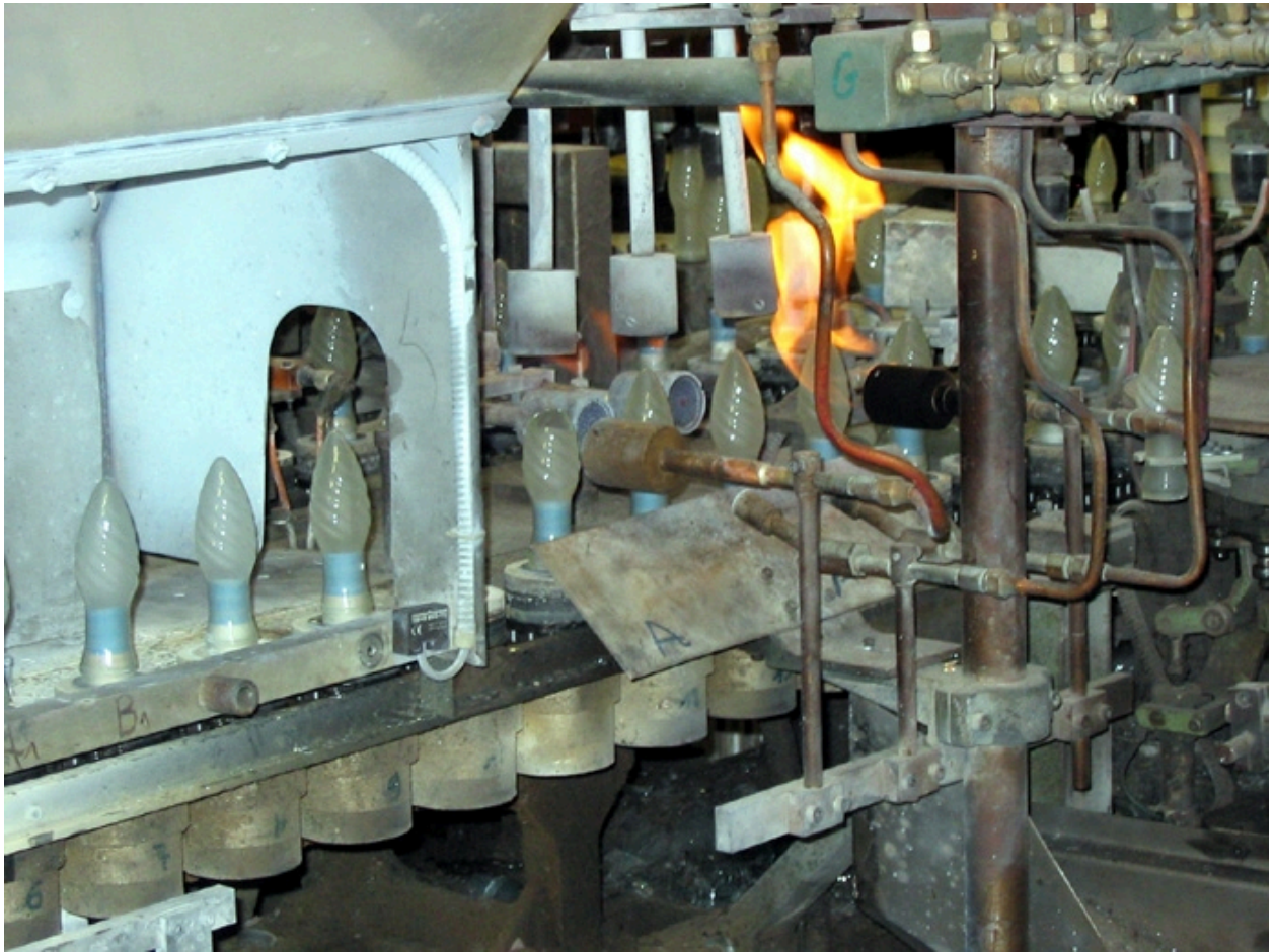
Atelier lampe, séparation du ballon
