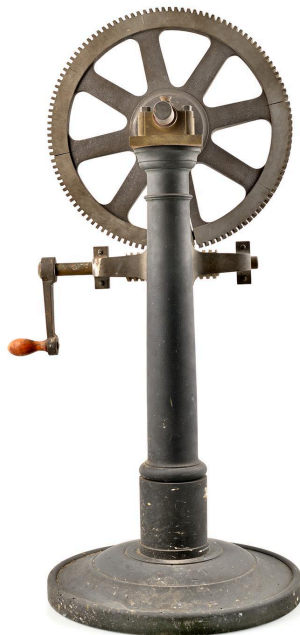
Treuil avec vis sans fin, vue de derrière Phot. Thierry Leroy IVR84_20256901793NUCA
