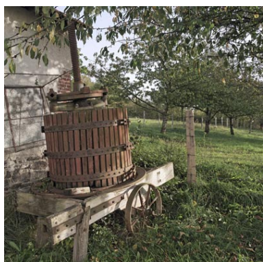
Pressoir mobile monté sur roue, à Pierre Murée. Phot. Didier Gourbin IVR82_20064201198NUCA
