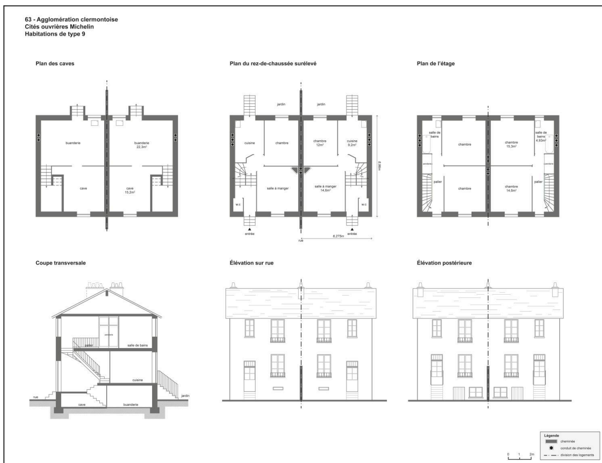
Plan des habitations d'employés de type 9, présentes côté est de l'avenue de la République vers 1930.
