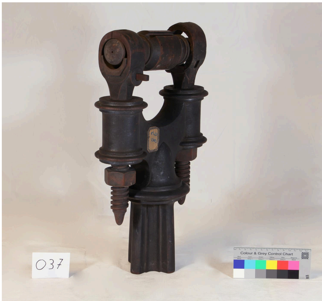
Tendeur composé de deux têtes de bielles, vue de côté
