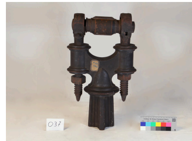
Tendeur composé de deux têtes de bielle Phot. Krystelle Besson , Phot. Mirco Meier, Phot. Marion Petit IVR84_20256901025NUCA
