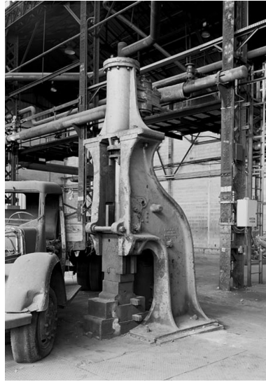
Petit marteau pilon (1950) usine Berliet-Renault-Trucks Vénissieux Phot. Martial Couderette IVR82_20006900828P
