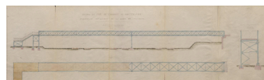
Passerelle métallique d'accès à la gare pour la traversée des voies PLM, plan et coupe. 1907 (AD Haute-Savoie : 4 S 11) Phot. Samir Mahfoudi IVR84_20257401609NUCA
