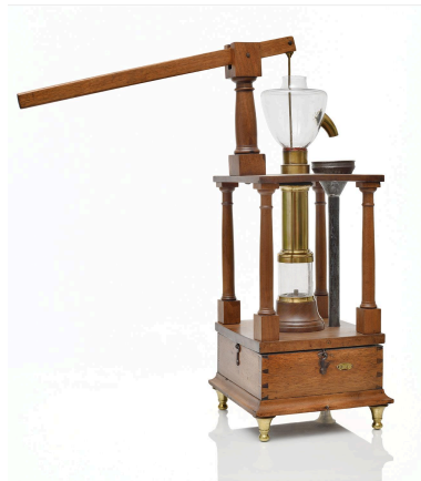
Pompe aspirante et foulante, vue 2 Phot. Thierry Leroy IVR84_20256902010NUCA
