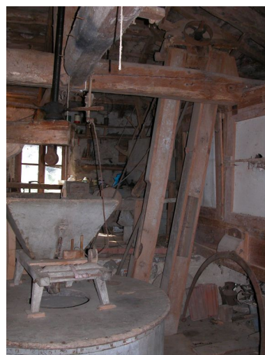
Rez-de-chaussée surélevé, détail de la trémie des meules. Phot. Thierry Monnet
