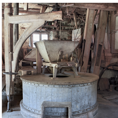
Vue d'ensemble du système de mouture. Phot. Didier Gourbin IVR82_20064200829NUCA
