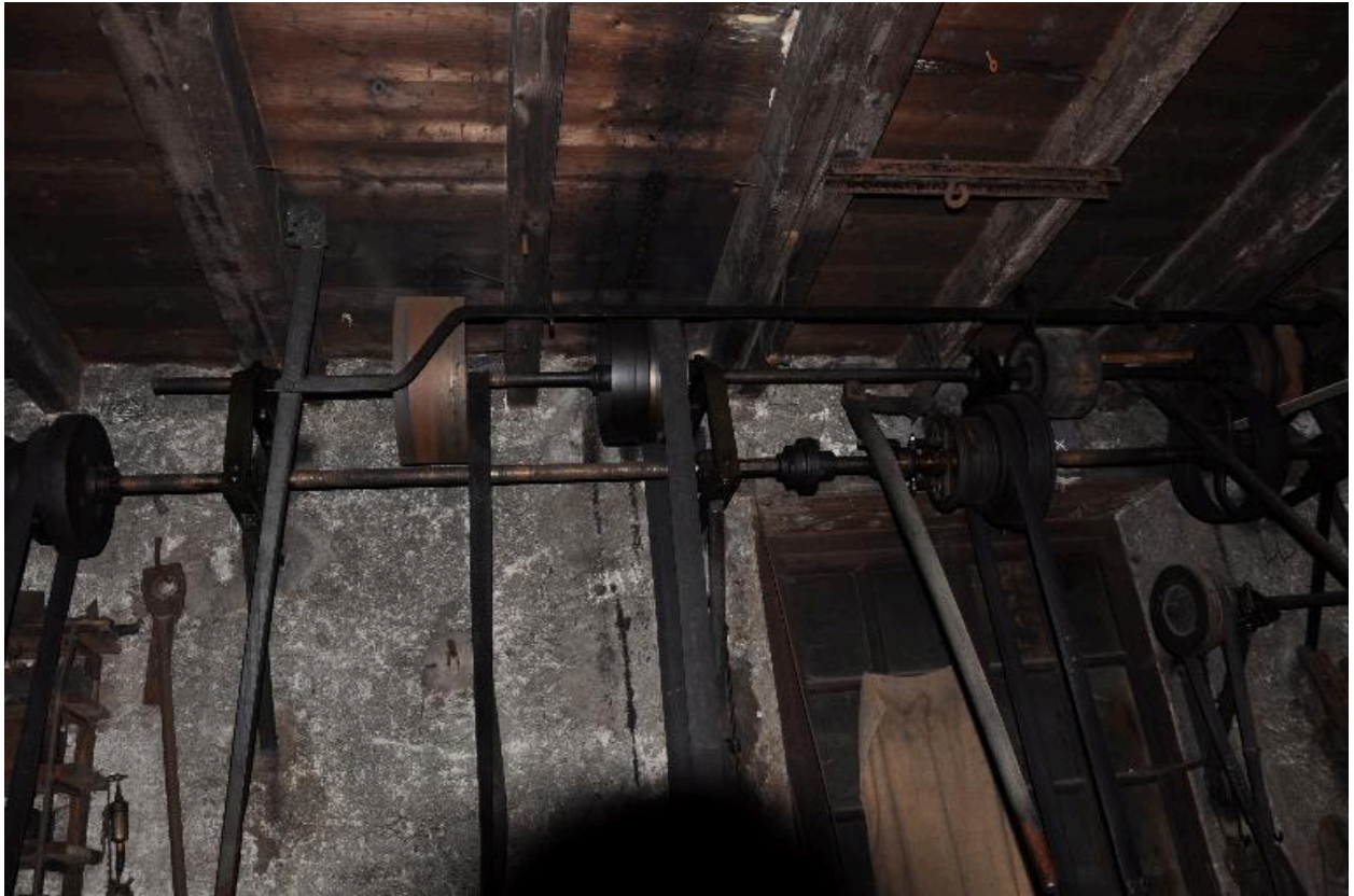
Vue intérieure de l'atelier : les mécanismes actionnés par la roue hydraulique.
