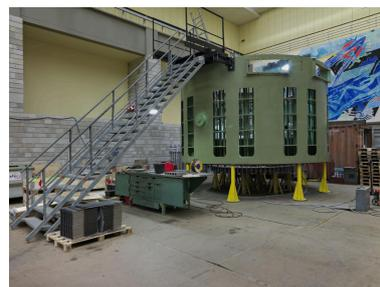
Stator de l'alternateur du groupe 6 démonté qui servira à la reconstruction du stator du groupe suivant rénové augmenté en puissance
