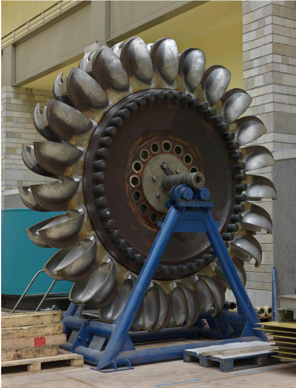
Roue Pelton (à augets) 23 tonnes, 4 mètres de diamètre
