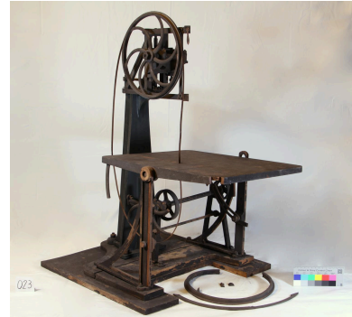
Plateau et lame de scie à ruban Phot. Krystelle Besson , Phot. Mirco Meier, Phot. Marion Petit IVR84_20256900998NUCA
