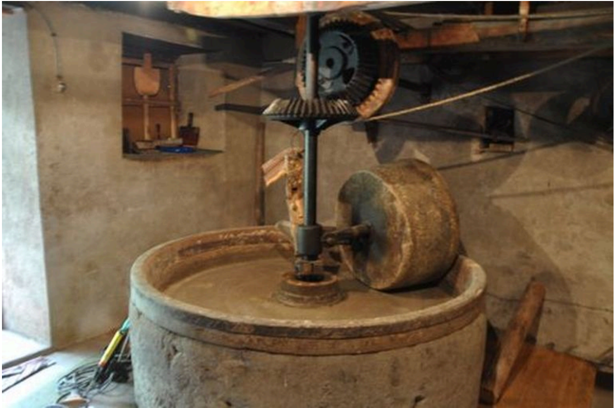
Pignon et arbre métalliques actionnant la meule tournante
