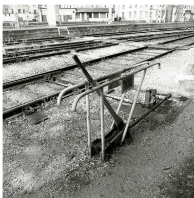
L'aiguille manuelle 103 actionnant les voies de service des porte-voitures Phot. Eric Dessert IVR82_20026903514X
