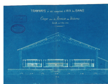
Dépôt des tramways : coupe Repro. François Fouger IVR82_20067300058NUCB
