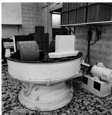
Concasseur, pâte à praline : de marque G. Herman-Paris Phot. Didier Gourbin IVR82_20036901767X
