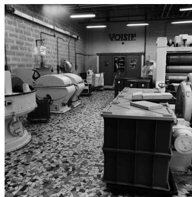
Broyeurs à pâte d'amande (rez-de-chaussée) Phot. Didier Gourbin IVR82_20036901745X
