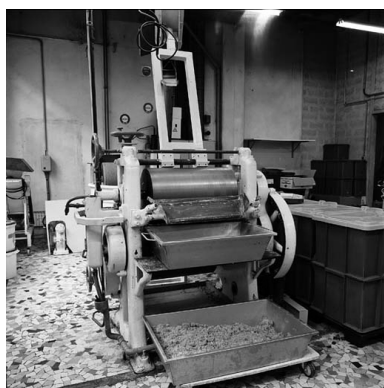
Machine à pâte de pralinées (rez-de-chaussée) Phot. Didier Gourbin IVR82_20036901768X
