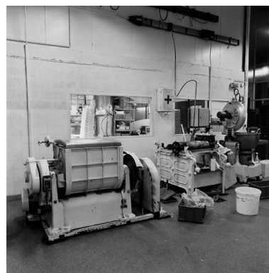
Machine : mélangeur pâte à coussin de Lyon Phot. Didier Gourbin IVR82_20036901735X
