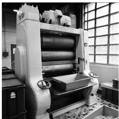
Broyeuse 5 cylindres, affineur : de marque Bobigny Ets Repiquet Phot. Didier Gourbin IVR82_20036901765X
