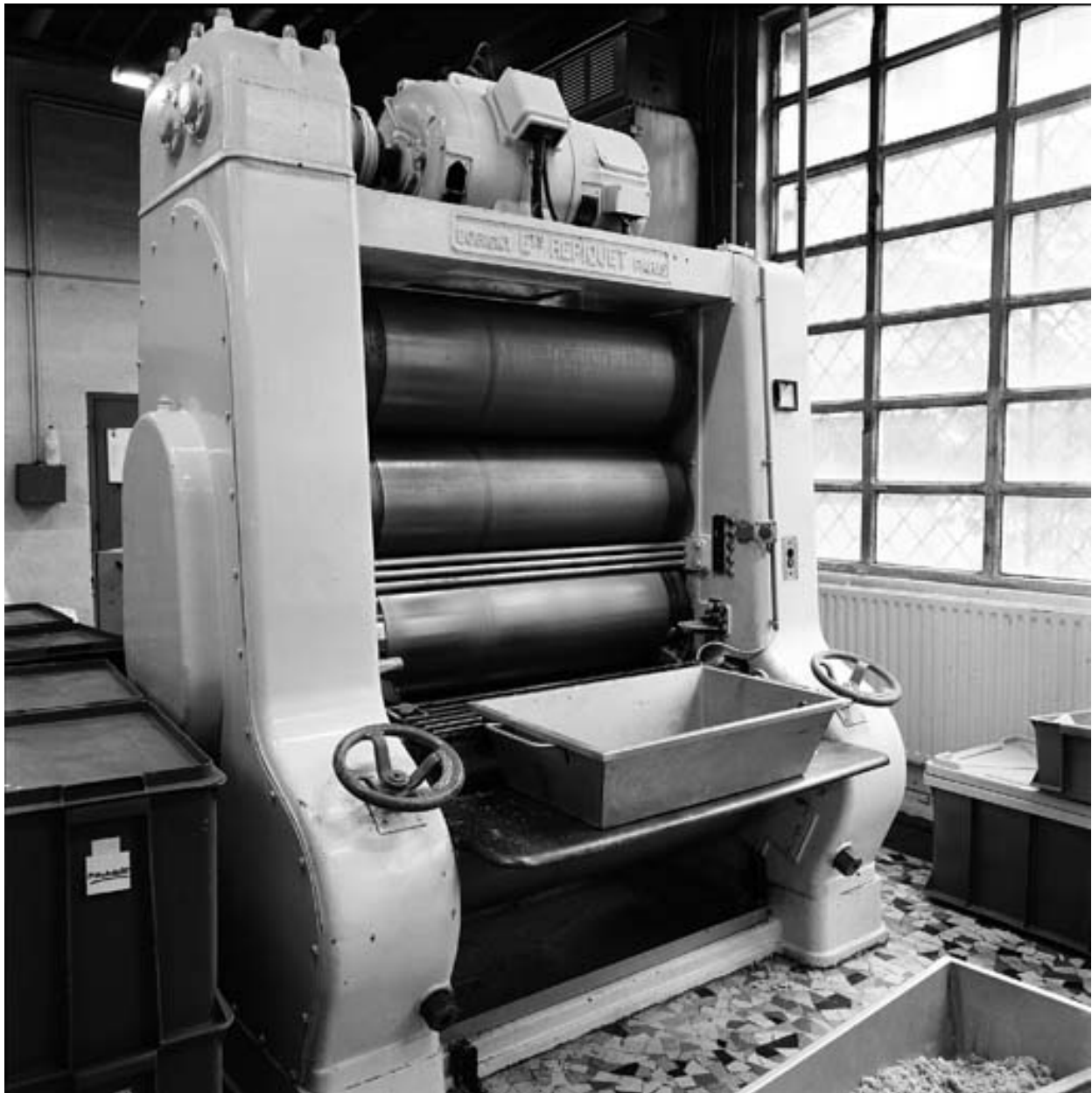
Broyeuse 5 cylindres, affineur : de marque Bobigny Ets Repiquet
