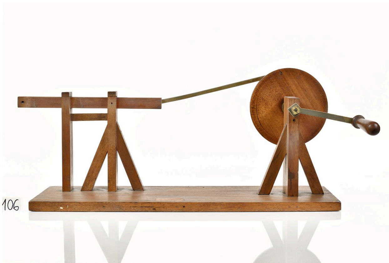
Mouvement circulaire continu changé en rectiligne alternatif, exemplaire 1, vue 1
