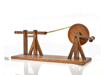
Mouvement circulaire continu changé en rectiligne alternatif, exemplaire 1, vue 3 Phot. Thierry Leroy IVR84_20256901814NUCA
