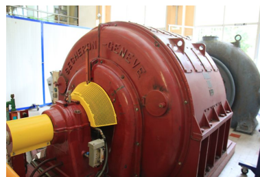
Alternateur de 3 800 Kw Phot. Samir Mahfoudi, Autr. Samir Mahfoudi IVR82_20117401209NUCA
