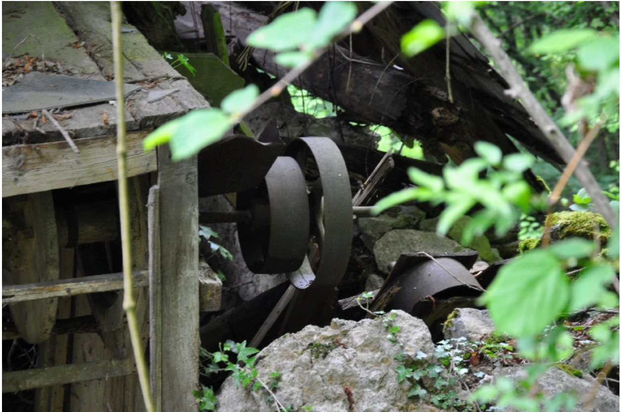
Détail des mécanismes du moulin avec les axes de la bluterie
