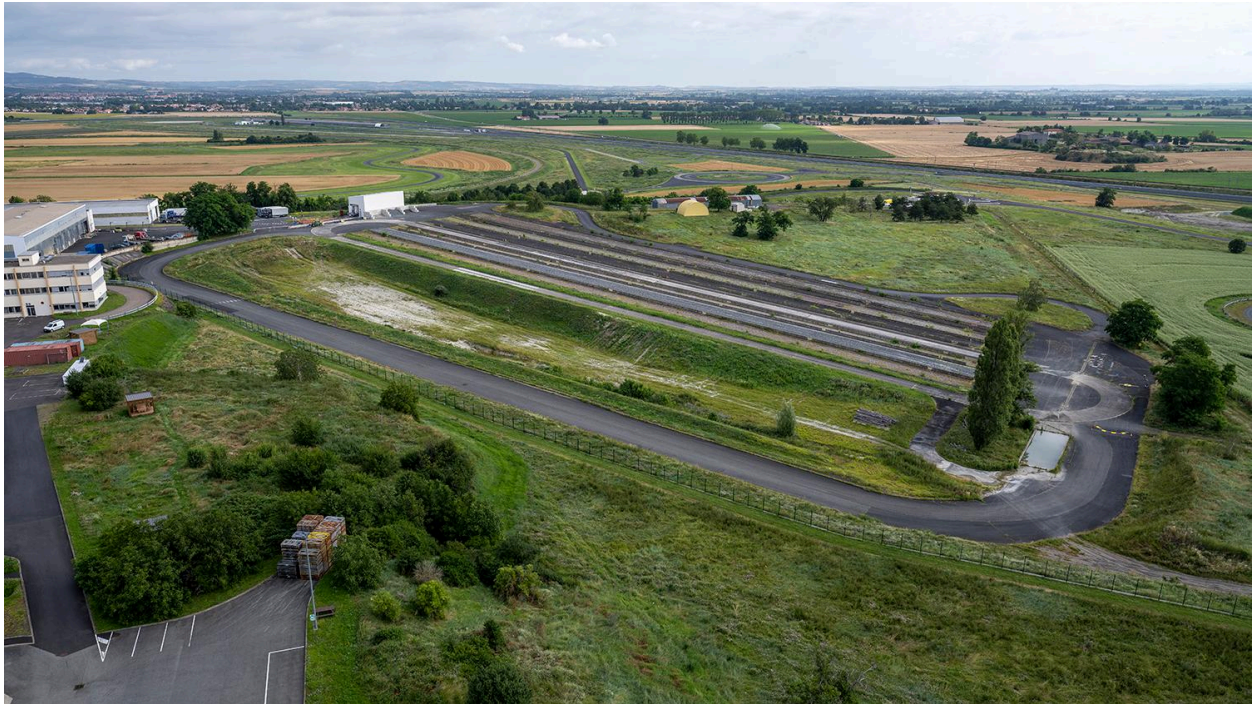
Vue aérienne de la partie est du site en 2024 : pistes d'essais pour les pneus de génie civil.
