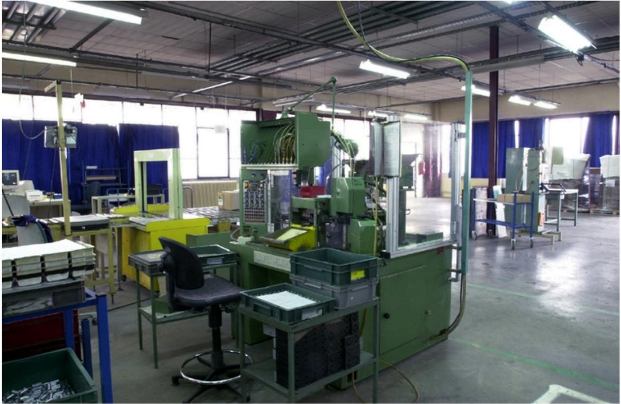
Machine Guilani, assemblage, 800 clés à l'heure
