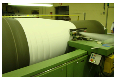
Atelier de texturation de la société Payen, avec ourdissoir métallique moderne (vue d'intérieur) Phot. Nadine Halitim-Dubois IVR82_20130700163NUCA
