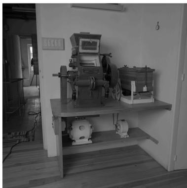
Broyeur et tamis d'essai.
