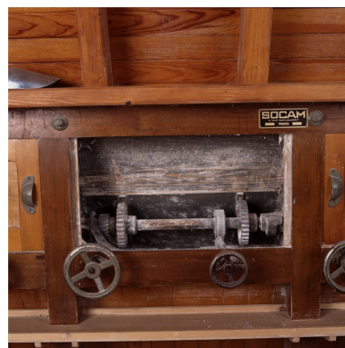
Détail de trémie, mélangeur (regard ouvert). Phot. Jean-Marie Refflé IVR82_19920100571XA
