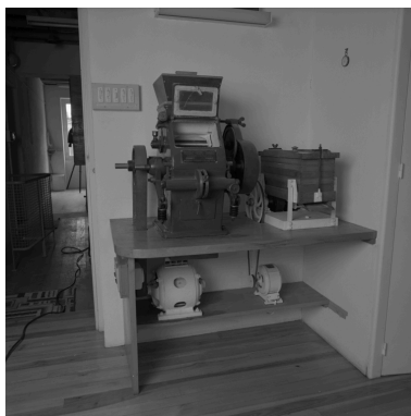
Broyeur et tamis d'essai. Phot. Jean-Marie Refflé IVR82_19920100588X
