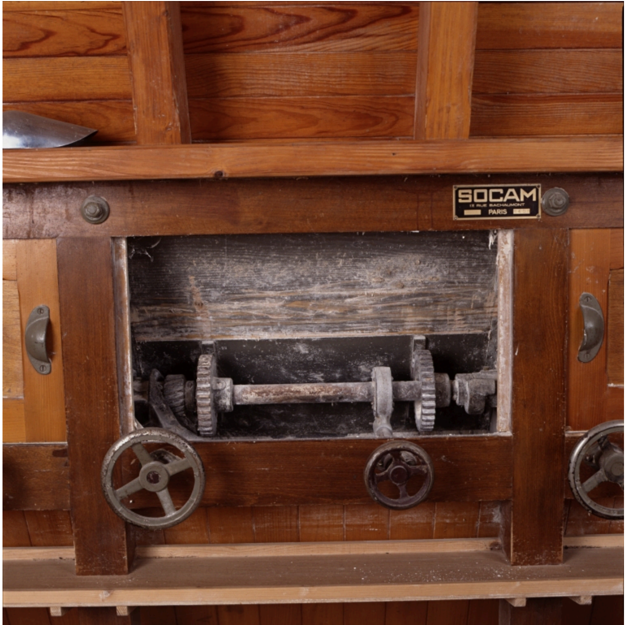
Détail de trémie, mélangeur (regard ouvert).
