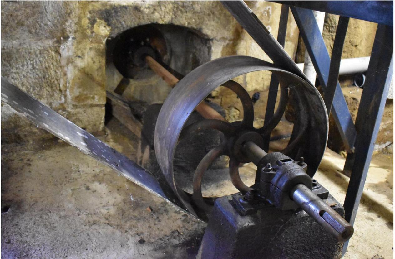
Sous-sol : détail du percement du mur nord et de l'engrenage de la turbine.
