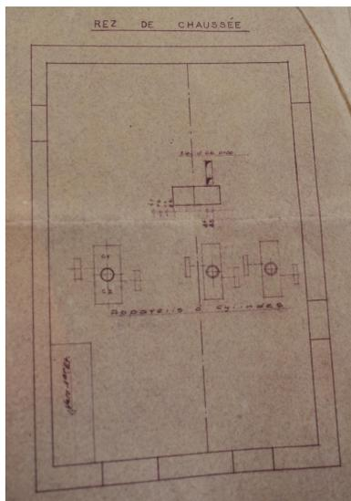
Plans d'aménagement du moulin par la société Cesbron d'Angers (années 1960) : rez-de-chaussée, emplacement des appareils à cylindres.
