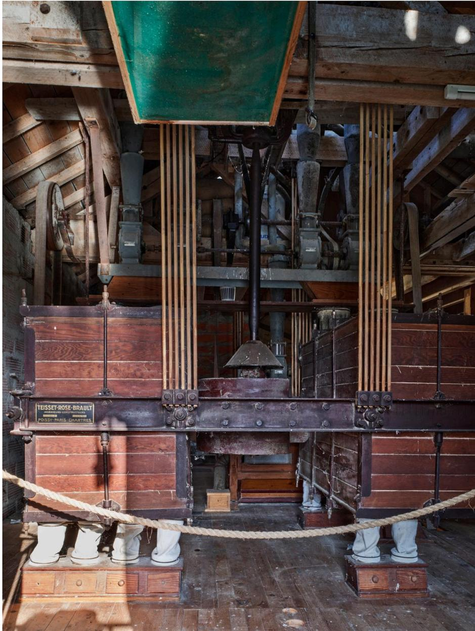
Vue du 2e étage : le plansichter avec le détail de la plaque du fabricant : "Teisset-Rose-Brault / ingénieurs constructeurs / Poissy-Paris-Chartres"
