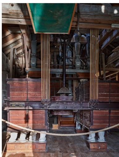
Vue du 2e étage : le plansichter avec le détail de la plaque du fabricant :
