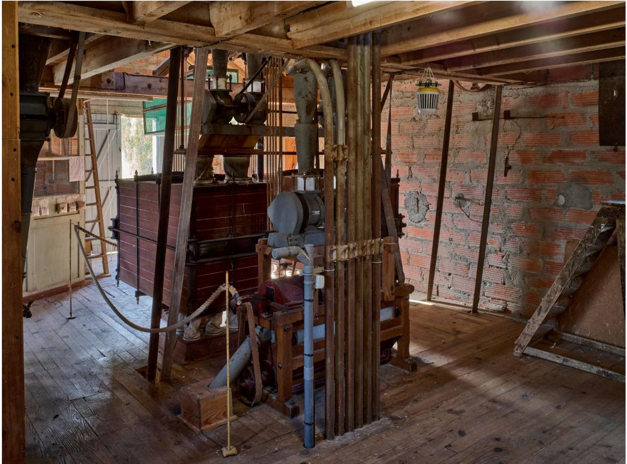
Vue du 2<sup>e</sup> étage : extracteur Cusson au premier plan, plansichter au second plan, porte double percée dans la façade en mur-pignon au nord en troisième plan.
