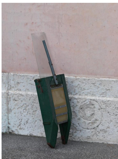
Drague à main et à manche utilisée pour les sédiments supérieurs Phot. Eric Dessert IVR82_20126901333NUCA
