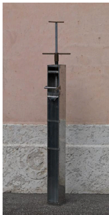
Carotier-main en aluminium de 1,20m (1,40m avec le manche) Phot. Eric Dessert IVR82_20126901331NUCA
