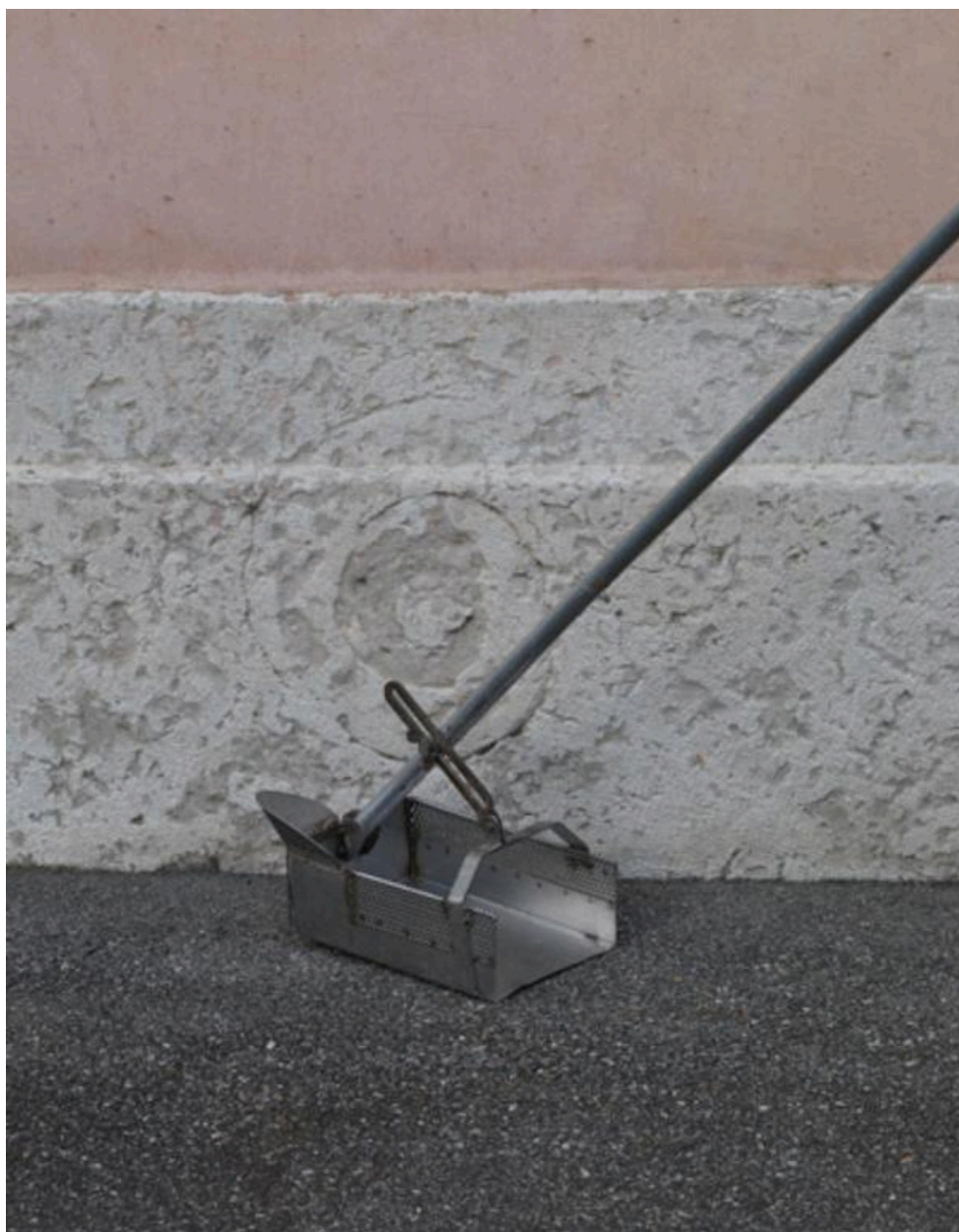
Carottier-lac avec treille de 1,80m mis devant le bateau sur le lac du Bourget
