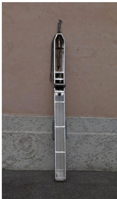
Carotier-main de 0,60m en bois (n'est plus utilisé) Phot. Eric Dessert IVR82_20126901326NUCA
