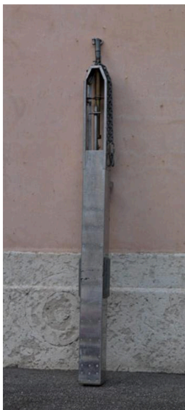
Carotier-main de 0,60m en bois (n'est plus utilisé) Phot. Eric Dessert IVR82_20126901329NUCA
