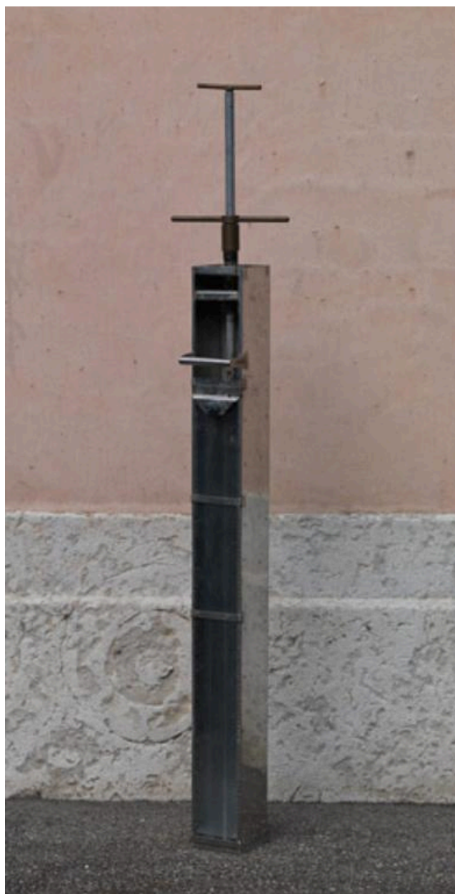
Carotier-main en aluminium de 1,20m (1,40m avec le manche)
