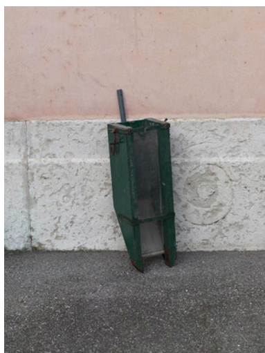
Drague à main et à manche utilisée pour les sédiments supérieurs Phot. Eric Dessert IVR82_20126901335NUCA
