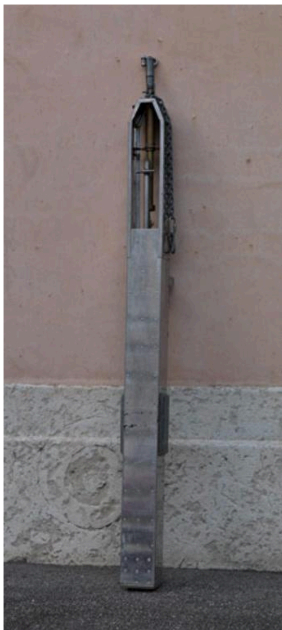
Carotier-main de 0,60m en bois (n'est plus utilisé)
