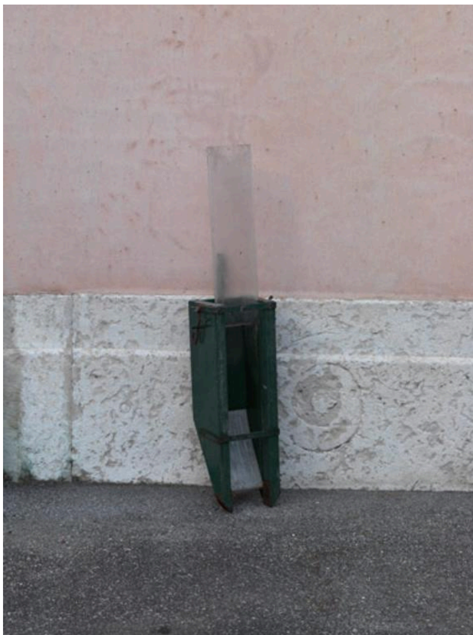
Drague à main et à manche utilisée pour les sédiments supérieurs
