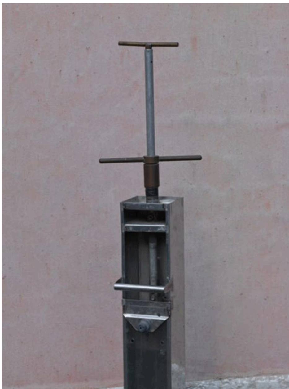
Carotier-main en aluminium de 1,20m (1,40m avec le manche)
