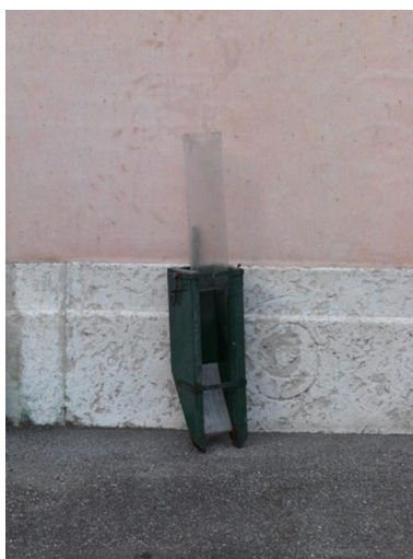
Drague à main et à manche utilisée pour les sédiments supérieurs Phot. Eric Dessert IVR82_20126901336NUCA
