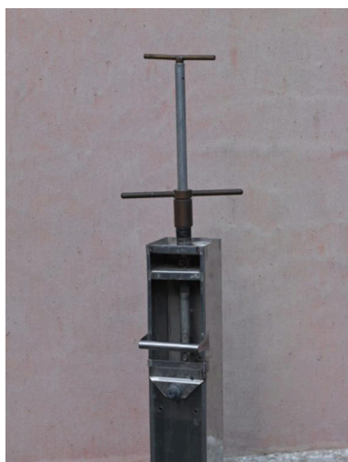
Carotier-main en aluminium de 1,20m (1,40m avec le manche) Phot. Eric Dessert IVR82_20126901332NUCA
