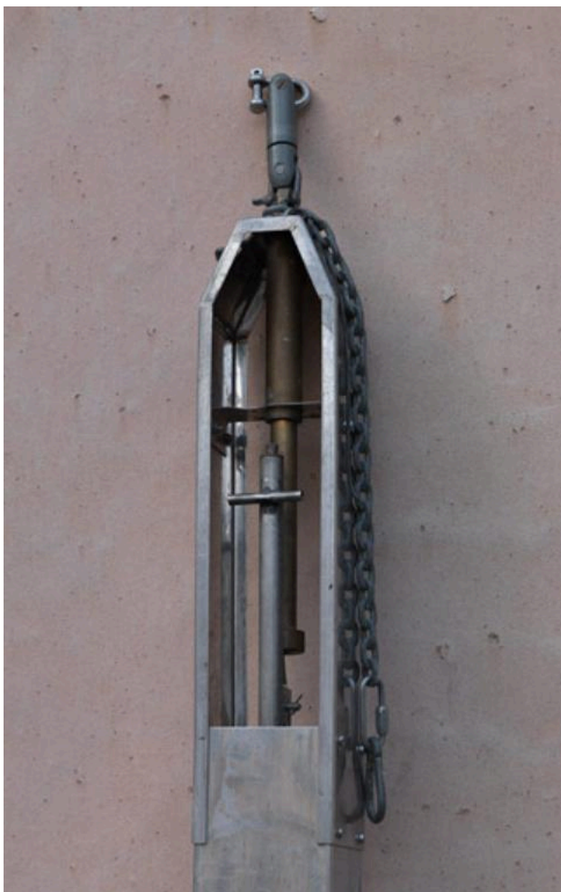
Carotier-main de 0,60m en bois (n'est plus utilisé)
