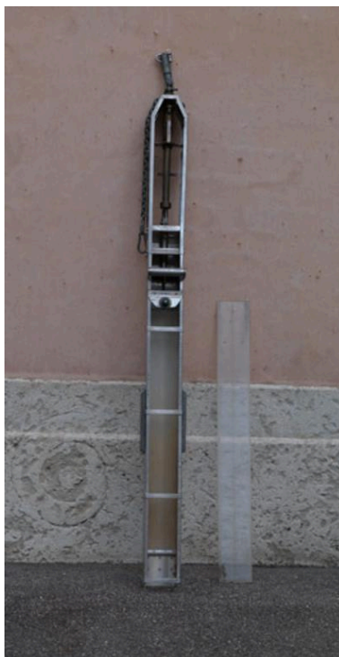
Carotier-main de 0,60m en bois (n'est plus utilisé) Phot. Eric Dessert IVR82_20126901327NUCA
