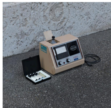
Electro-thermomètre de terrain Phot. Eric Dessert IVR82_20126901343NUCA
