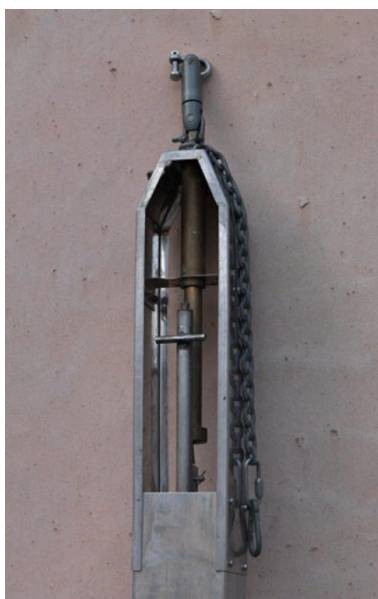
Carotier-main de 0,60m en bois (n'est plus utilisé) Phot. Eric Dessert IVR82_20126901330NUCA
