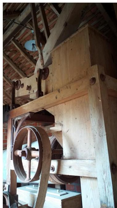
moulin 2, 1er étage : détail de la machine à épurer mécaniquement portant le nom du fabricant : "Teisset-Rose-Brault / ingénieurs-constructeurs / Poissy-Paris-Chartres". 1ère moitié du 20e siècle.
