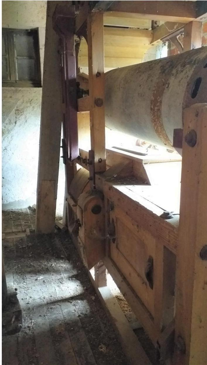
moulin 2, 1er étage : trieur à tambour métallique de la machine à épurer mécaniquement portant le nom du fabricant : "Teisset-Rose-Brault / ingénieurs-constructeurs / Poissy-Paris-Chartres". 1ère moitié du 20e siècle.
