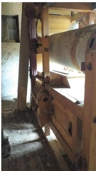
moulin 2, 1er étage : trieur à tambour métallique de la machine à épurer mécaniquement portant le nom du fabricant : "Teisset-Rose-Brault / ingénieurs-constructeurs / Poissy-Paris-Chartres". 1ère moitié du 20e siècle.
