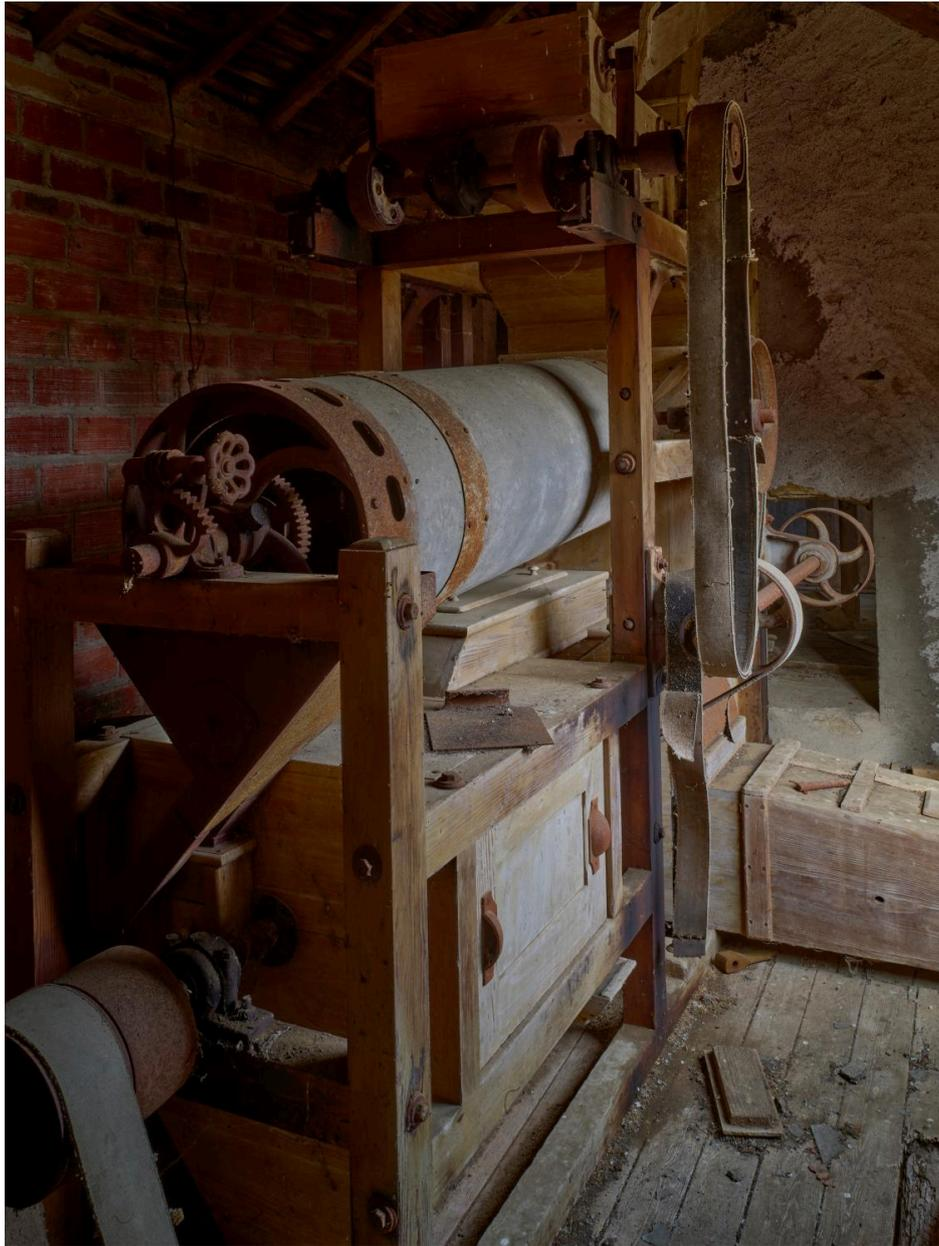
moulin 2, 1er étage : trieur à tambour métallique de la machine à épurer mécaniquement portant le nom du fabricant : "Teisset-Rose-Brault / ingénieurs-constructeurs / Poissy-Paris-Chartres". 1ère moitié du 20e siècle.
