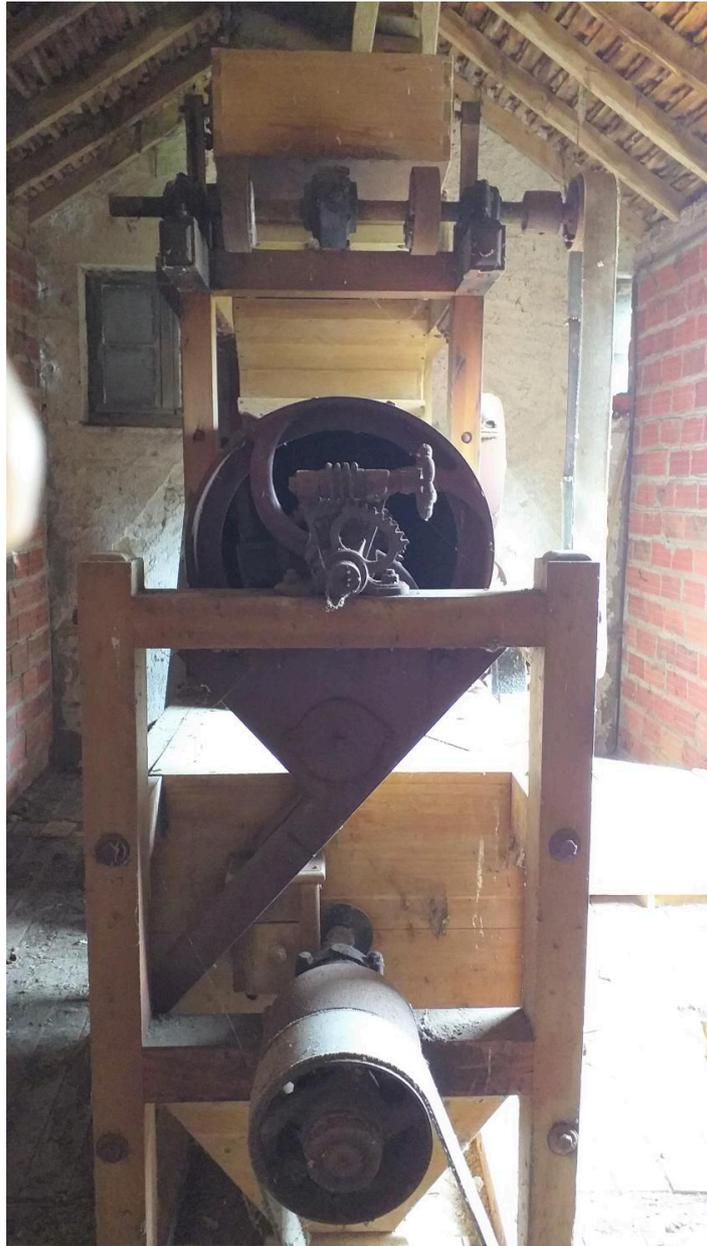
moulin 2, 1er étage : détail du trieur à tambour métallique de la machine à épurer mécaniquement portant le nom du fabricant : "Teisset-Rose-Brault / ingénieurs-constructeurs / Poissy-Paris-Chartres". 1ère moitié du 20e siècle.
