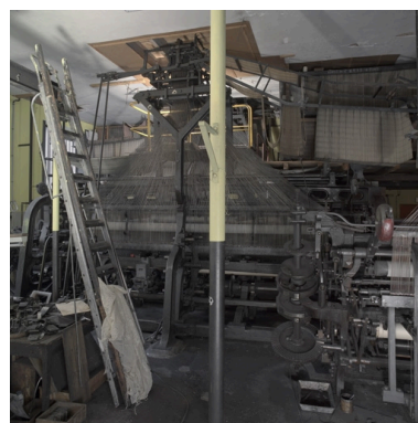
Métier dentelle : Johnson 13,2 points vue arrière
