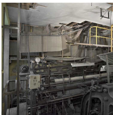
Métier dentelle : Johnson 11, 2 points (cf plan) détail système jacquard cartons
