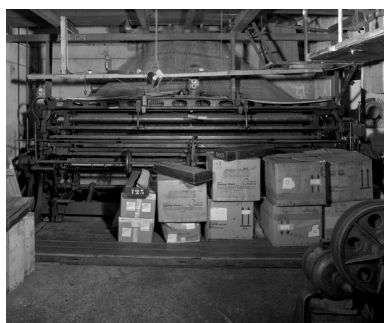
Métier dentelle : moteur Malécot dit métier Bils (à l'arrêt pour les pièces)
