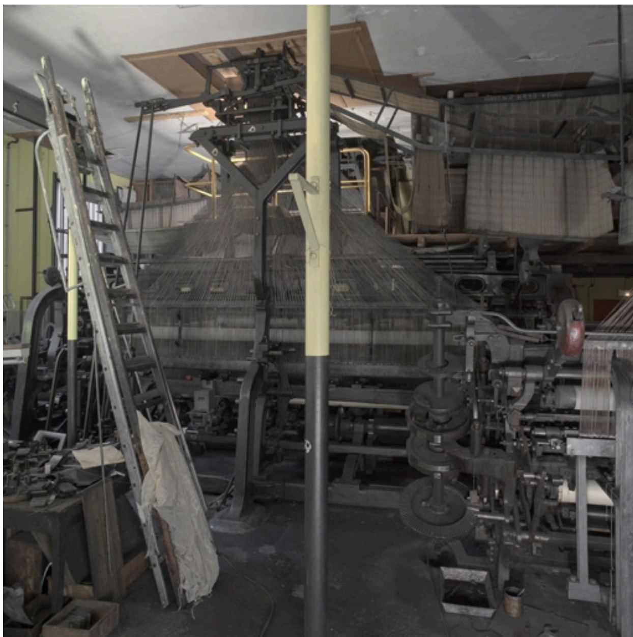
Métier dentelle : Johnson 13,2 points vue arrière
