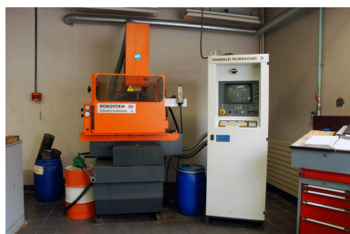
Atelier outillage : électro- érosion Roboform R20 Phot. Catherine Guégan IVR82_20116901829NUCA
