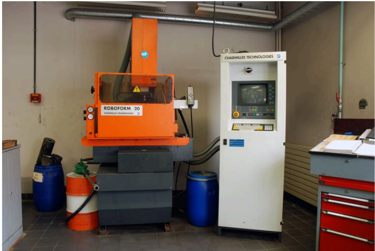
Atelier outillage : électro-érosion Roboform R20
