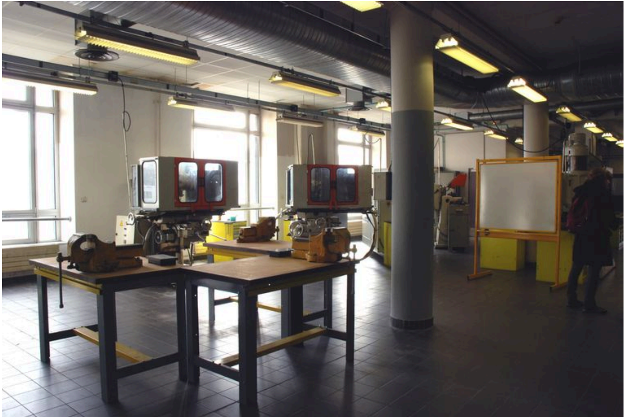
Atelier outillage : Etablis, fraiseuse traditionnelle DUFOUR et tour CAZENEUVE CNCT200 semi numérique
