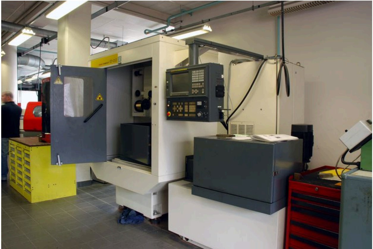
Atelier outillage : électro-érosion à fil Alpha cut
