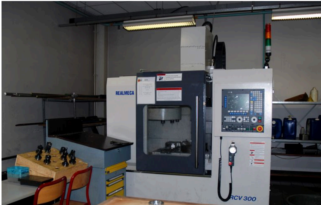
Atelier outillage : centre d'usinage REALMECA RCV300
