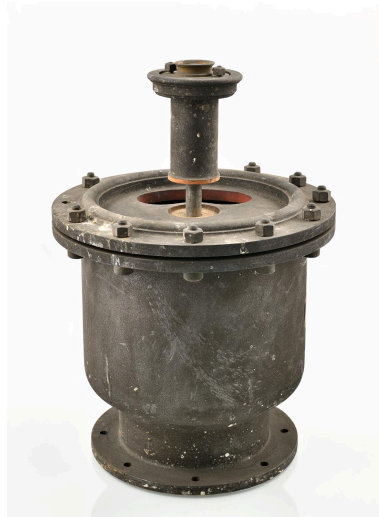
Soupape de sûreté, vue 2 Phot. Thierry Leroy IVR84_20256901796NUCA
