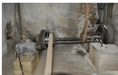
Vue du moteur électrique et des systèmes d'entraînement. Phot. Caroline Guibaud IVR82_20157402866NUCA
