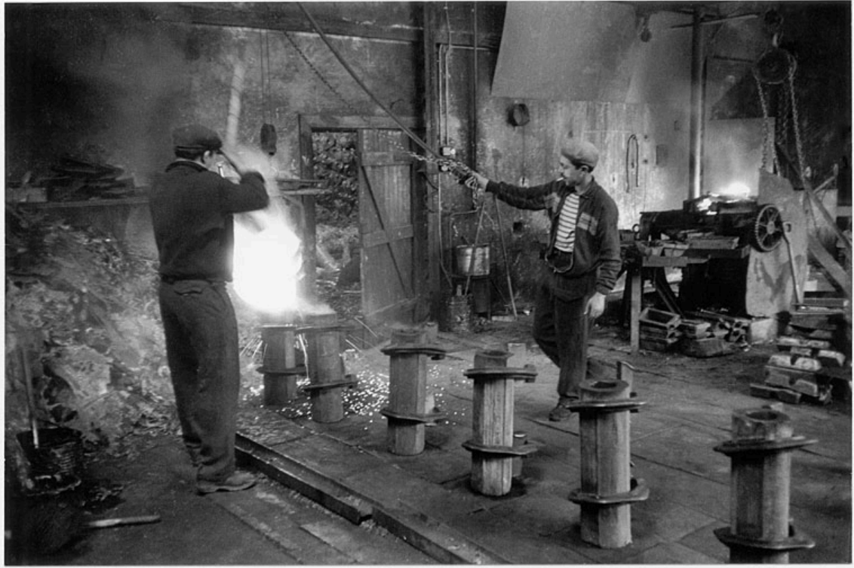
Coulée du cuivre en fusion dans la ligne des lingotières
