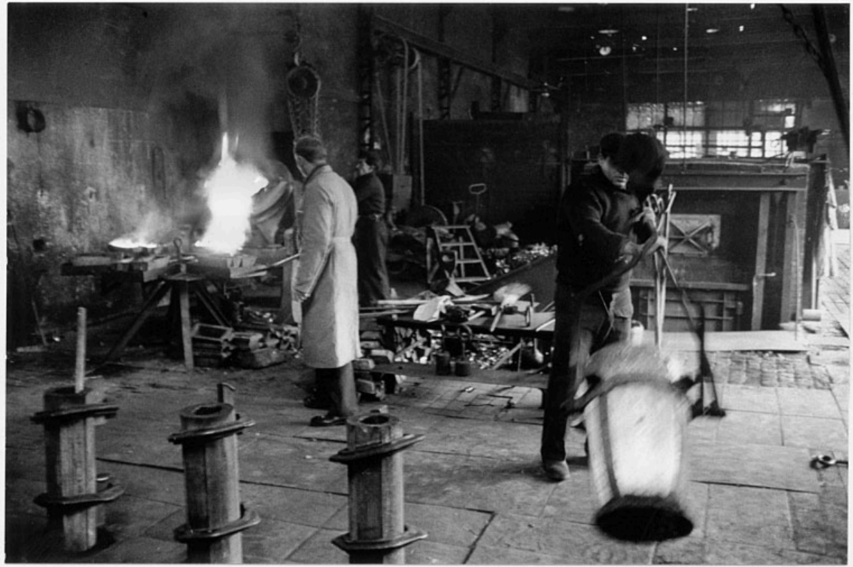
Sortie du creuset en fusion (phase 4)
