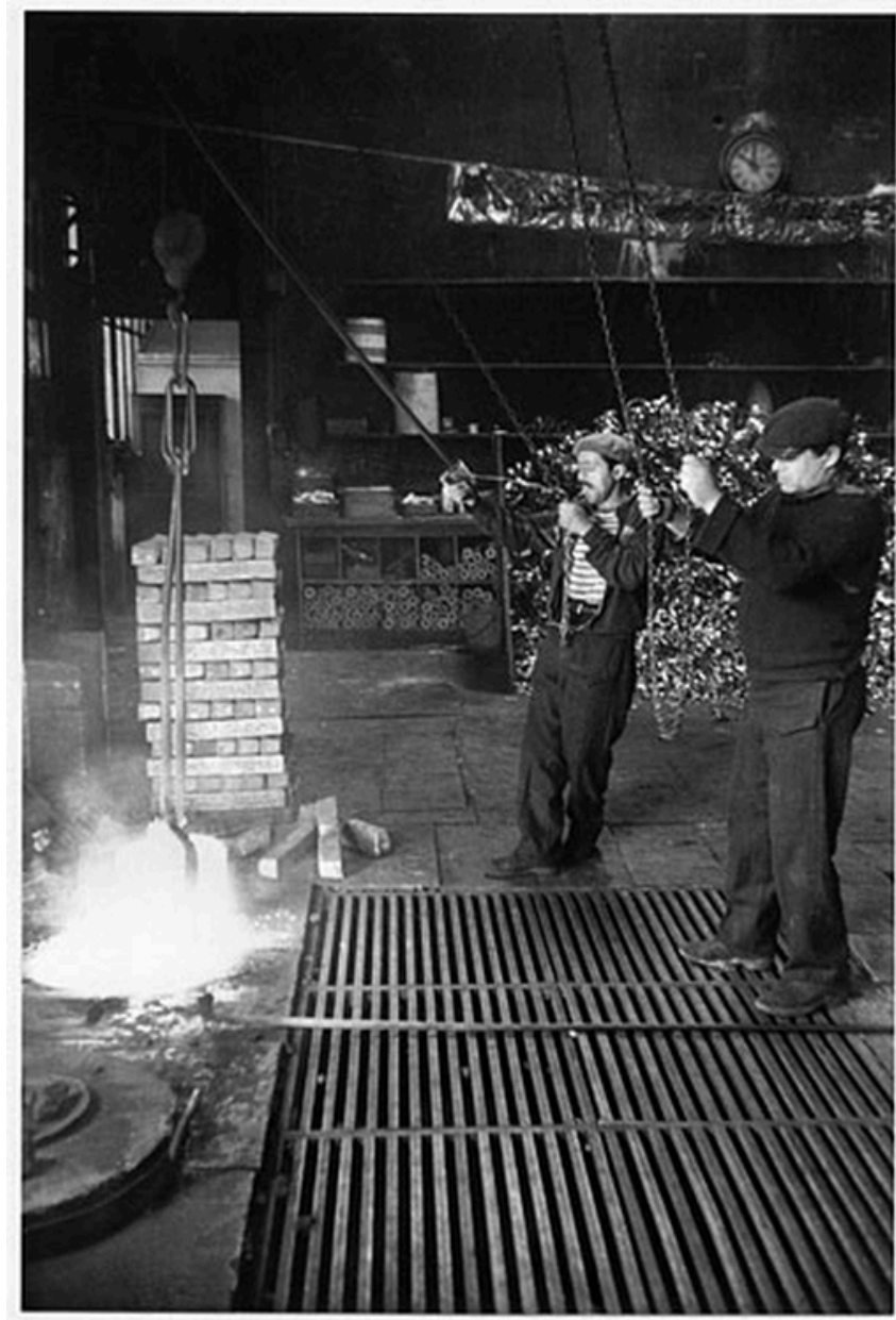
Sortir du creuset en fusion (phase 2)
