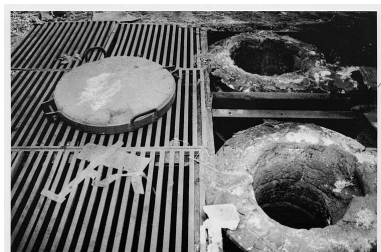
Atelier fonderie désaffecté : vue des deux fours à cuivre Repro. Nadine Halitim-Dubois IVR82_20016903406NUCB
