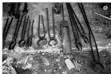
Outillage : pinces à creuset et pelles à four Repro. Nadine Halitim-Dubois IVR82_20016903410NUCB
