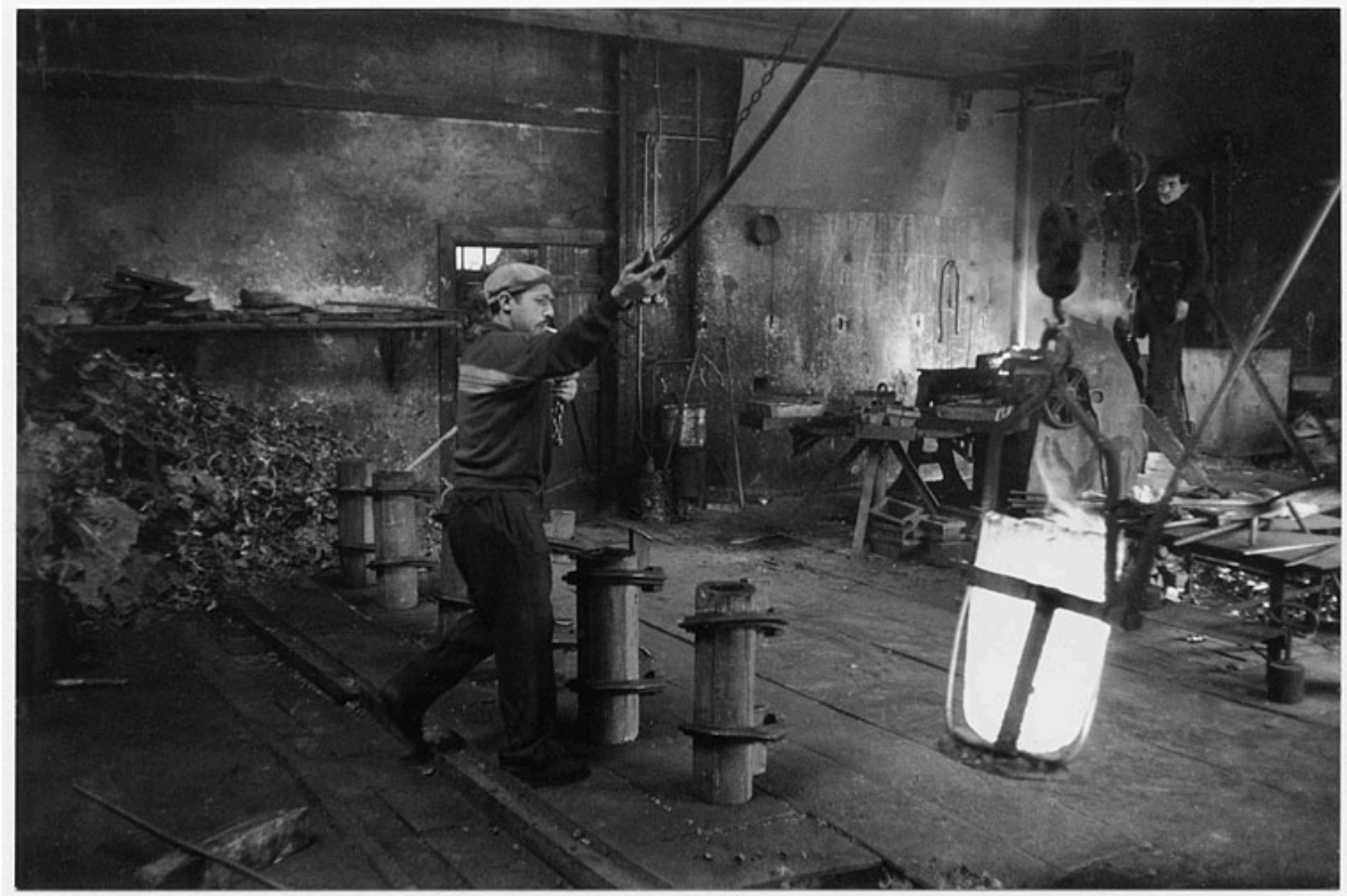
Sortie du creuset en fusion (phase 5)
