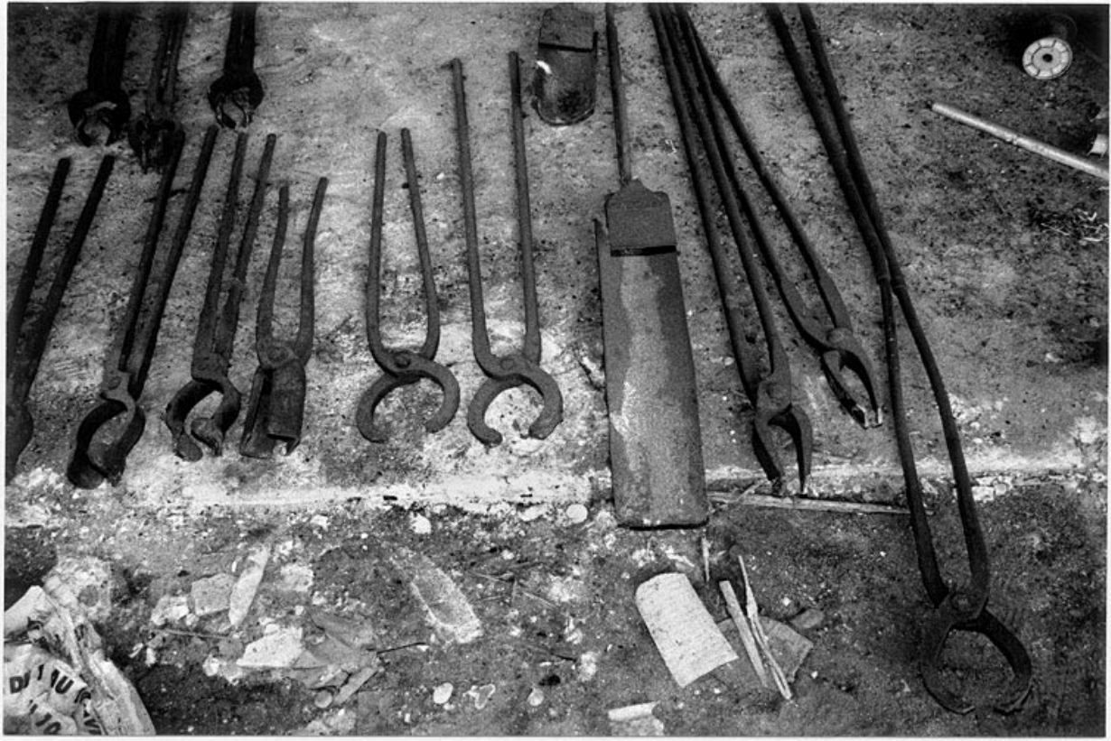
Outillage : pinces à creuset et pelles à four
