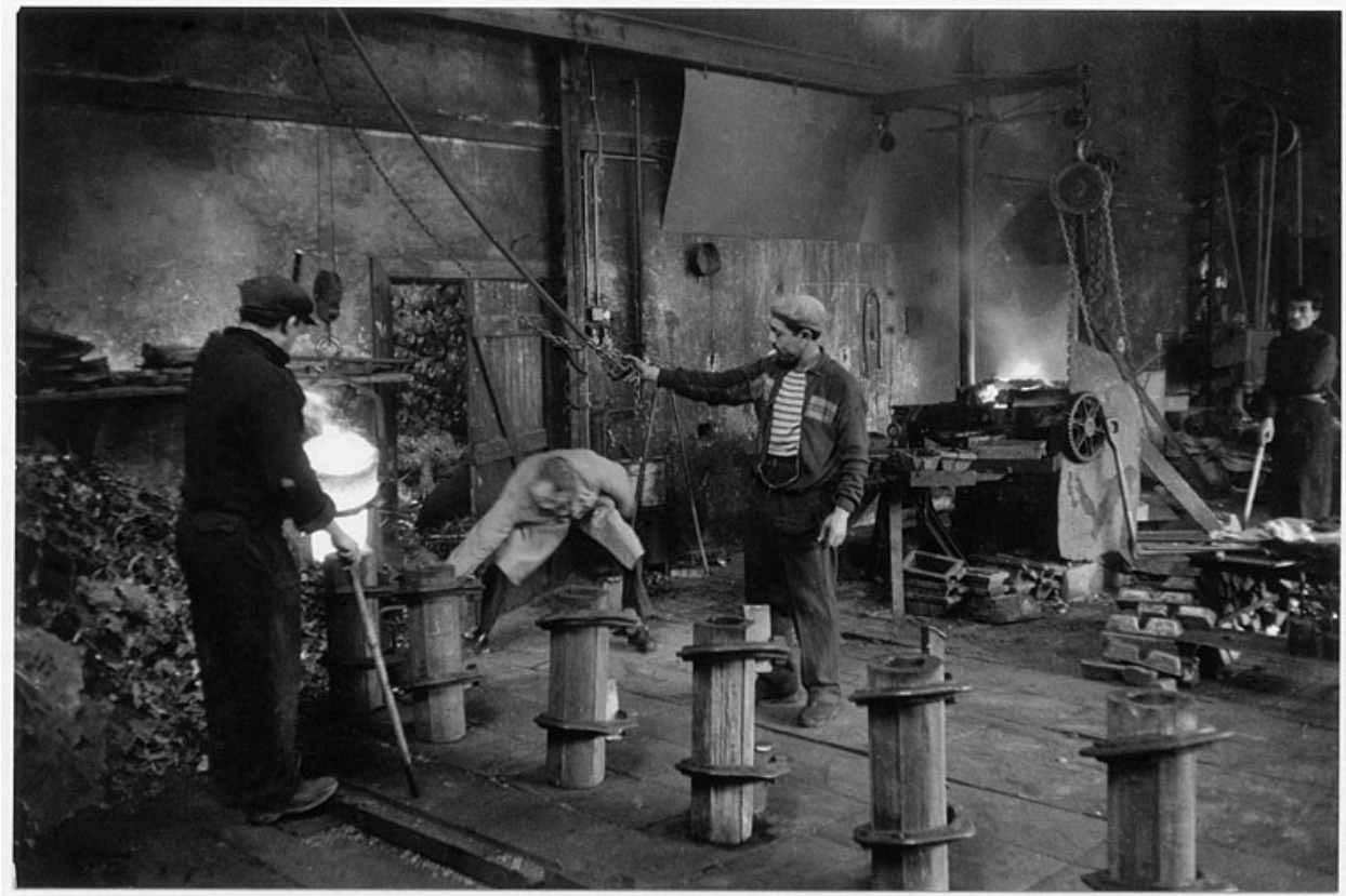
Préparation à la coulée du cuivre en fusion dans les lingotières
