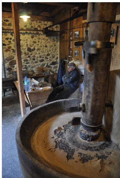
Vue intérieure du moulin à huile avec la meule en action au premier plan Phot. Yannick Milleret IVR82_20127301618NUCA
