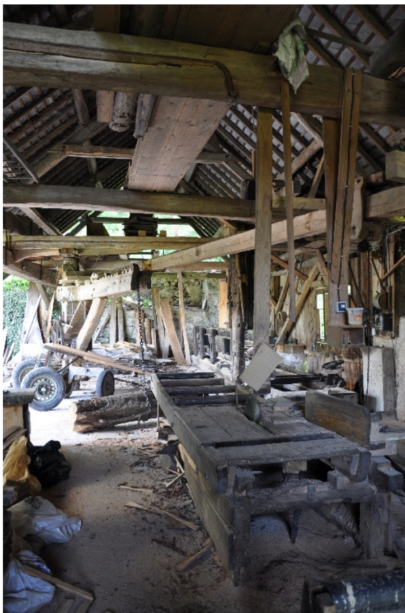
Vue de la scierie avec l'outillage (scie circulaire, treuil, chariot, courroies,...)
