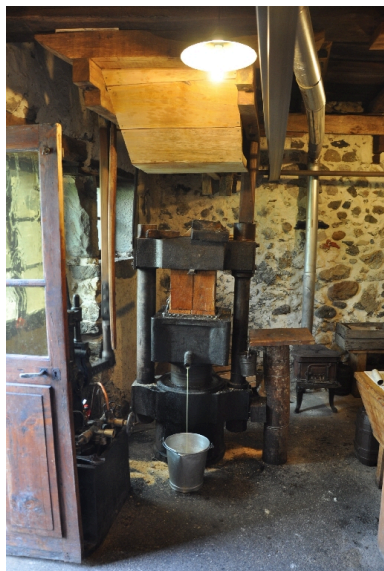
Vue intérieure du moulin à huile avec la presse Phot. Yannick Milleret IVR82_20127301615NUCA
