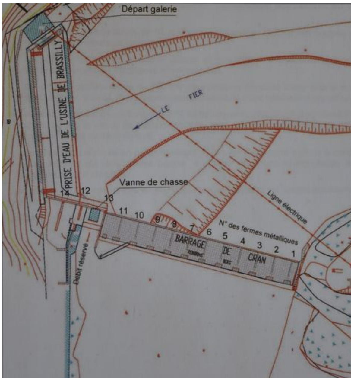
Barrage de Cran- Schéma descriptif des installations existantes. 2004. Plan. © Archives Direction départementale de l'Équipement et de l'Agriculture de Haute-Savoie. Carton Brassilly
