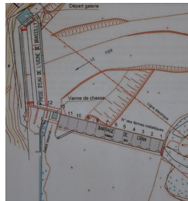
Barrage de Cran- Schéma descriptif des installations existantes. 2004. Plan. © Archives Direction départementale de l' Équipement et de l'Agriculture de Haute-Savoie. Carton Brassilly Phot. Samir Mahfoudi, Autr. Direction départementale de l'Équipement et de l' Agriculture de Haute-Savoie IVR82_20107400336NUCA
