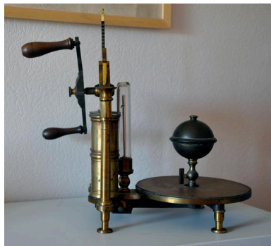
Machine pneumatique à deux corps de pompe et hémisphères de Magdebourg Phot. Catherine Guégan IVR84_20201500177NUCA
