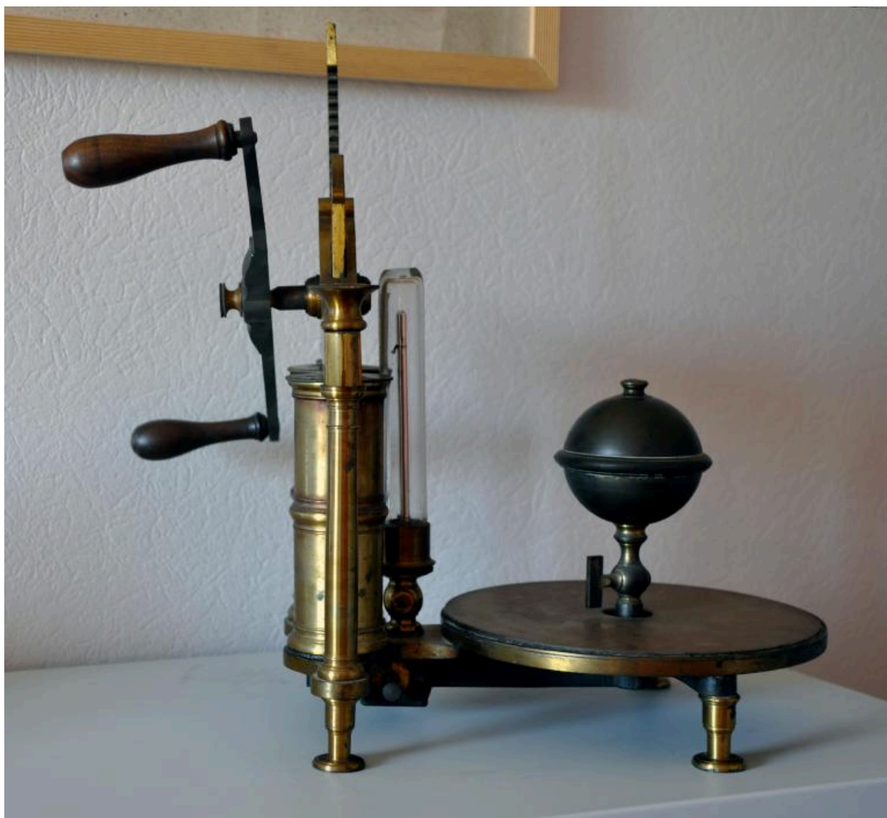
Machine pneumatique à deux corps de pompe et hémisphères de Magdebourg
