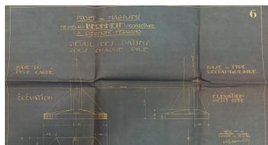
Système d'ancrage des piles
