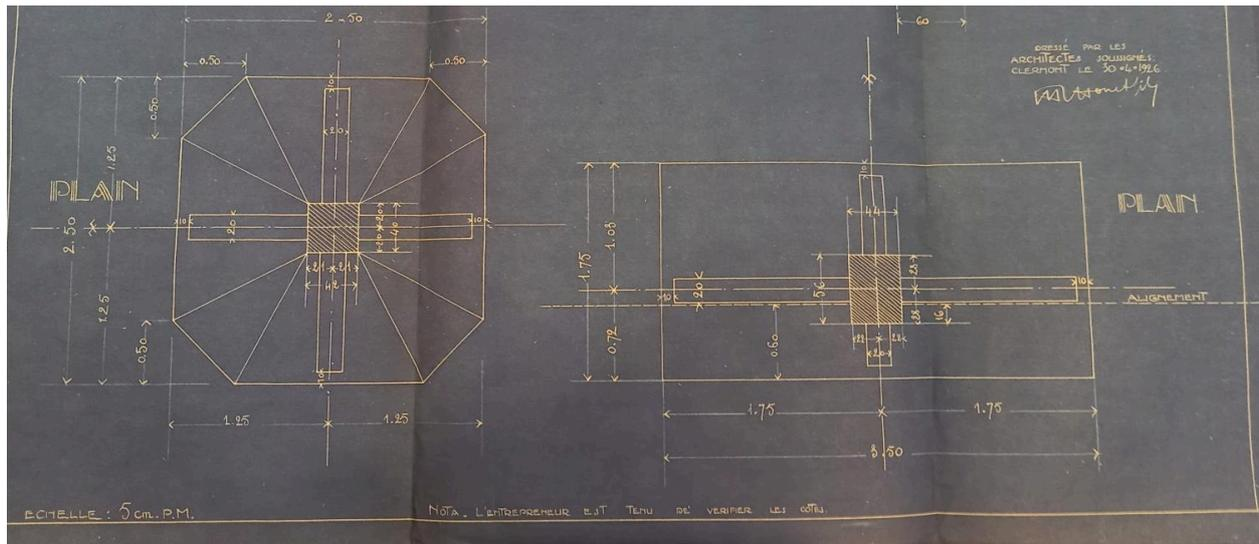
Plan du système d'ancrage des piles
