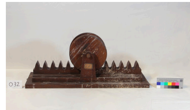
Modèle d'engrenage à crémaillère à lanterne Phot. Krystelle Besson , Phot. Mirco Meier, Phot. Marion Petit IVR84_20256901015NUCA
