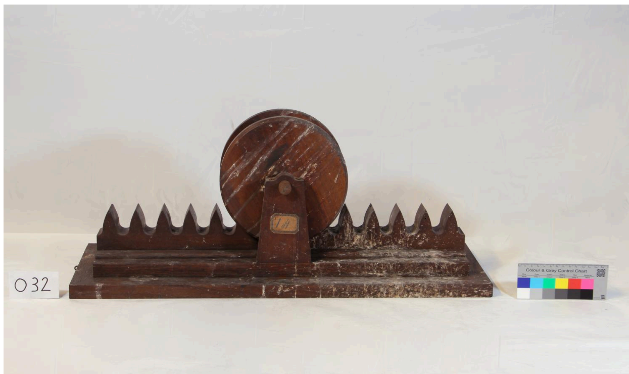
Modèle d'engrenage à crémaillère à lanterne
