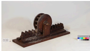
Modèle d'engrenage à crémaillère, vue de côté Phot. Krystelle Besson , Phot. Mirco Meier, Phot. Marion Petit IVR84_20256901016NUCA
