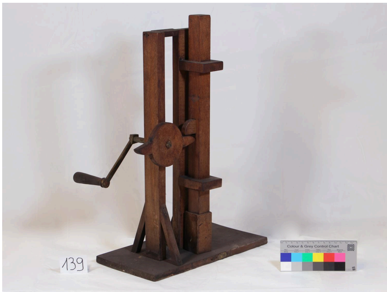
Marteau pilon n°2, vue de côté
