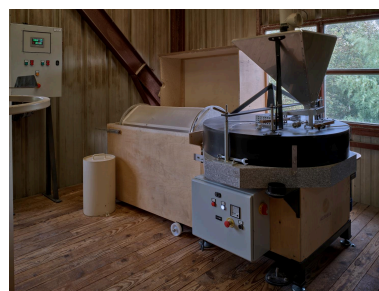
Premier étage : machine dite moulin Astréia ou Astrier. Phot. Christian Parisey IVR84_20240300468NUC4A
