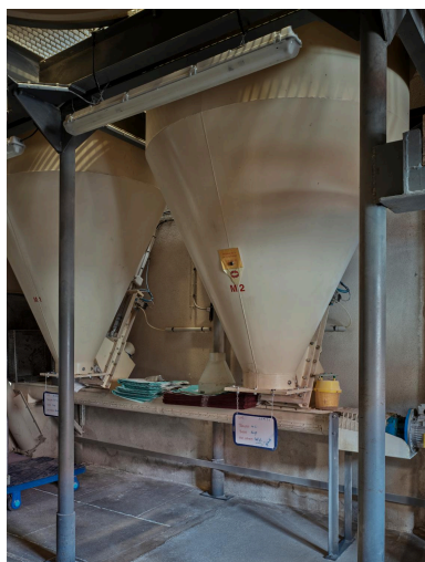
Rez-de-chaussée, mélangeuses de blés. Phot. Christian Parisey IVR84_20240300465NUC4A
