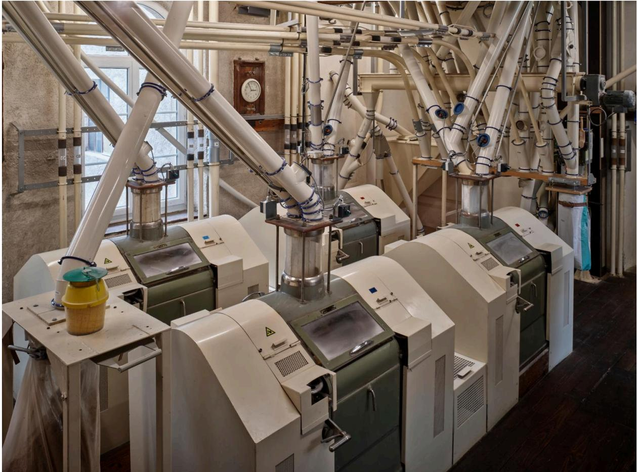
Rez-de-Chaussée : broyeurs, convertisseurs et claqueurs.
