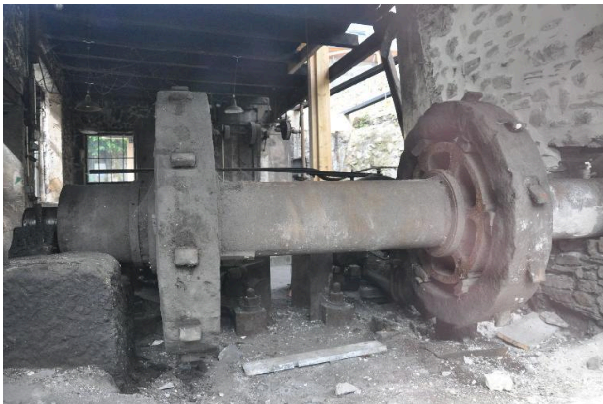
Arbre à cames actionnant les martinets, 2014.
