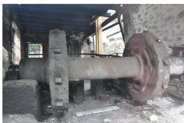
Arbre à cames actionnant les martinets, 2014. Phot. Clara Bérelle IVR82_20157301634NUCA
