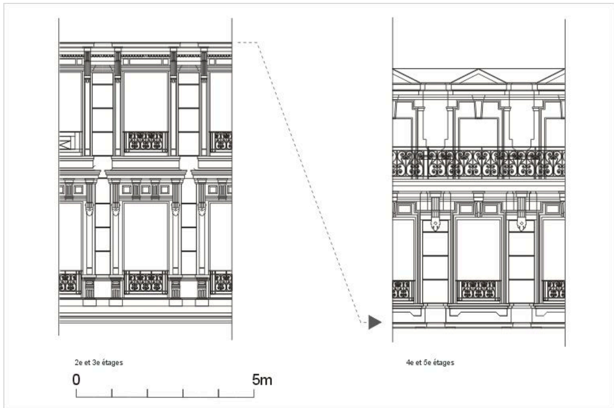
Elévation de la façade sur la rue de Brest, détails, d'après un relevé photogrammétrique par A. Bensaci, 2003
