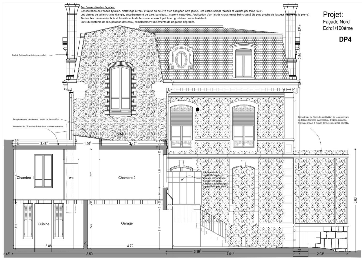
Elévation et coupe nord, projet de restauration
