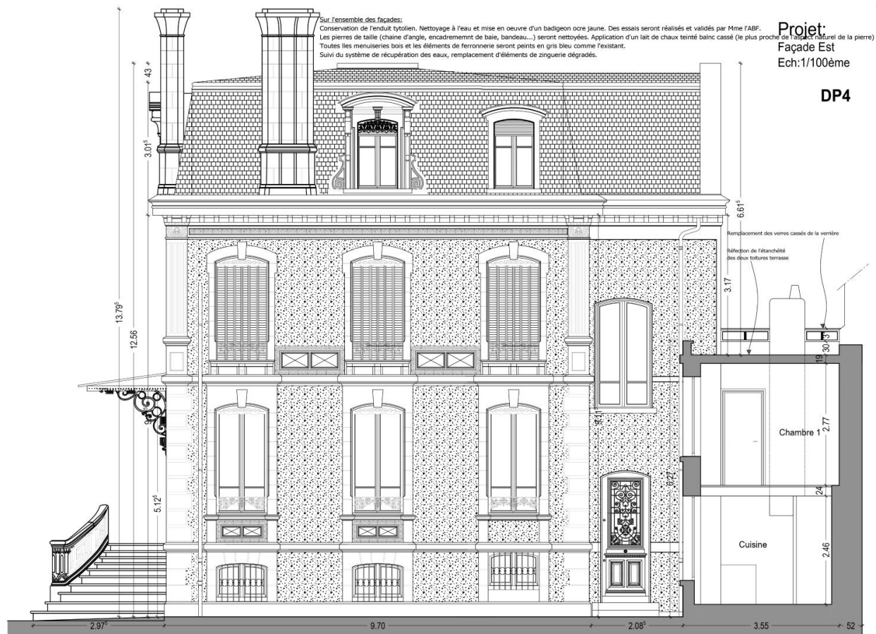
Elévation est, projet de restauration
