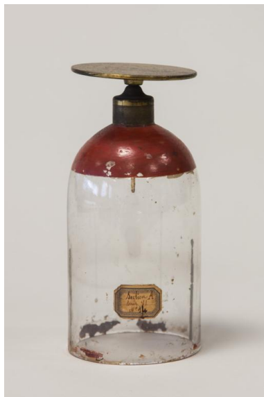
Électroscope condensateur Phot. Pascal Lemaître IVR82_20152600207NUCA
