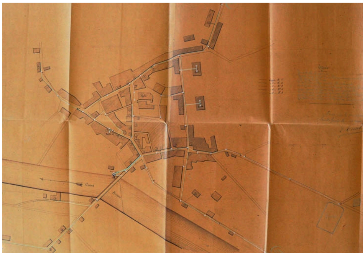
Plan du réseau de distribution de l'énergie électrique à partir de la centrale hydroélectrique, 1891. Plan du réseau de distribution de l'énergie électrique à partir de la centrale hydroélectrique, 1891 AD Savoie. 81S62
