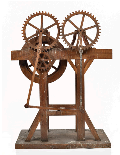
Modèle d'engrenage à mouvement continu Phot. Thierry Leroy IVR84_20256902005NUCA
