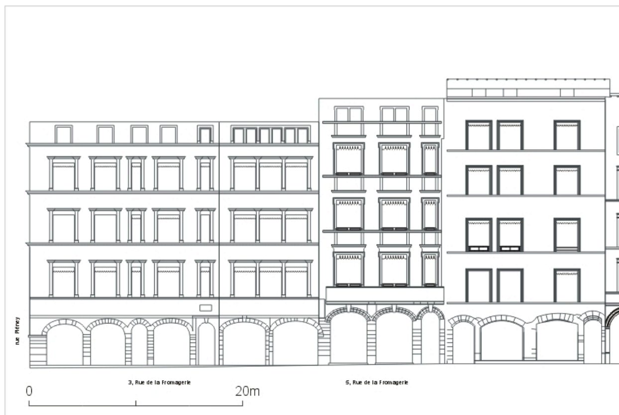
Rue de la Fromagerie, élévation des façades du côté nord, partie gauche, d'après un relevé photogrammétrique par A. Bensaci, 2005
