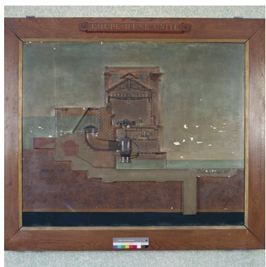
Plâtre : coupe d'une unite (turbine) Phot. Didier Gourbin IVR82_20026904458XE
