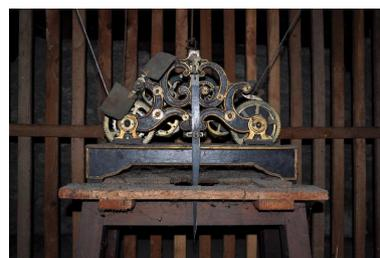
Mécanisme de l'horloge
