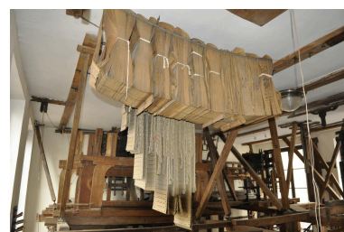
Cartons perforés de la mécanique jacquard : Atelier de tissage à bras de Georges Mattelon en 2016 Phot. Nadine Halitim-Dubois IVR84_20166900056NUCA
