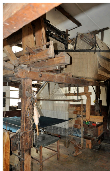
Métier grande largeur (140cm x 180 cm) dit "Grand métier" Damas sous envers : atelier de tissage à bras de Georges Mattelon en 2016 Phot. Nadine Halitim-Dubois IVR84_20166900060NUCA
