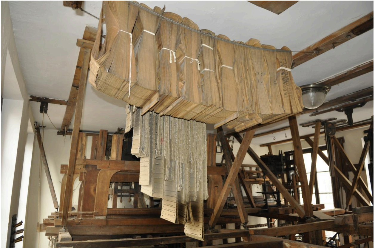
Cartons perforés : Atelier de tissage à bras de Georges Mattelon en 2016
