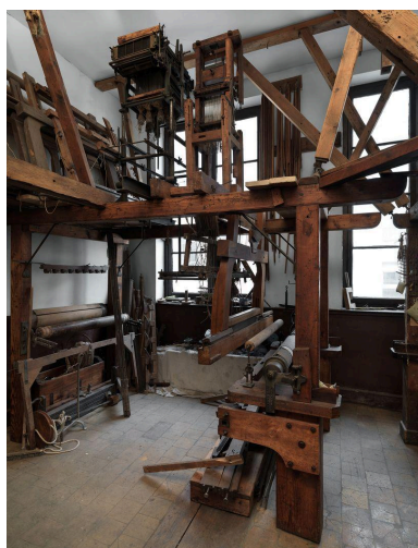
Métier à bras pour nouveauté petite largeur (54cm x 70cm) en cours de montage Phot. Thierry Leroy IVR84_20166901262NUCAQ
