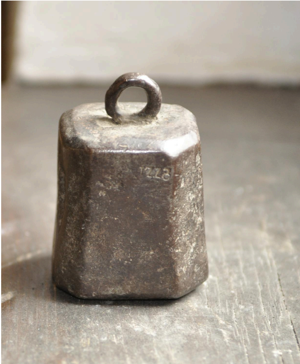
Poids métallique avec indication de mesure, qui servent à maintenir les fils rendus : atelier de tissage à bras de Georges Mattelon
