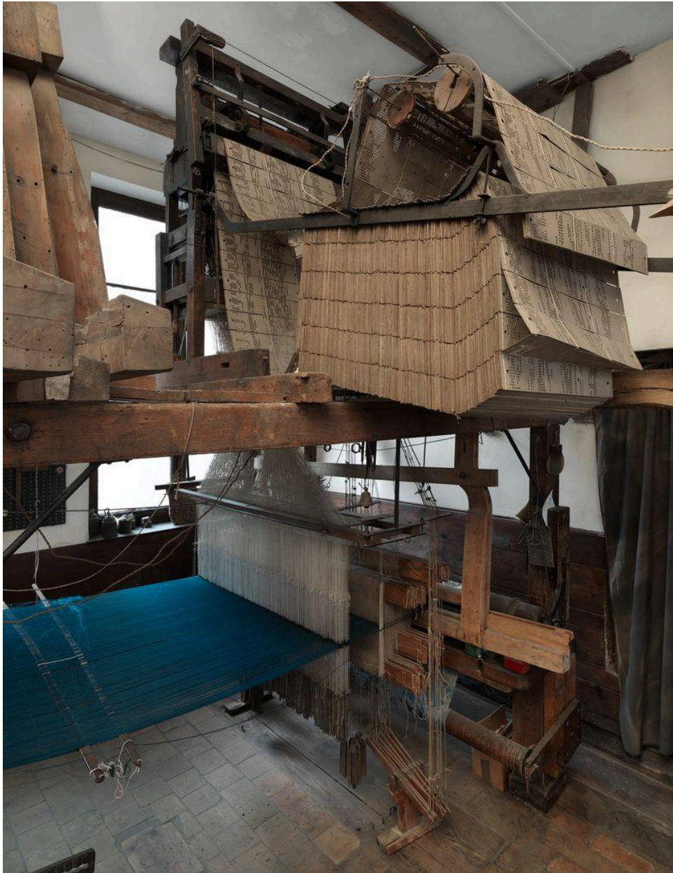
Détail mécanique jacquard : métier grande largeur (140cm x 180 cm) dit "Grand métier" Damas sous envers
