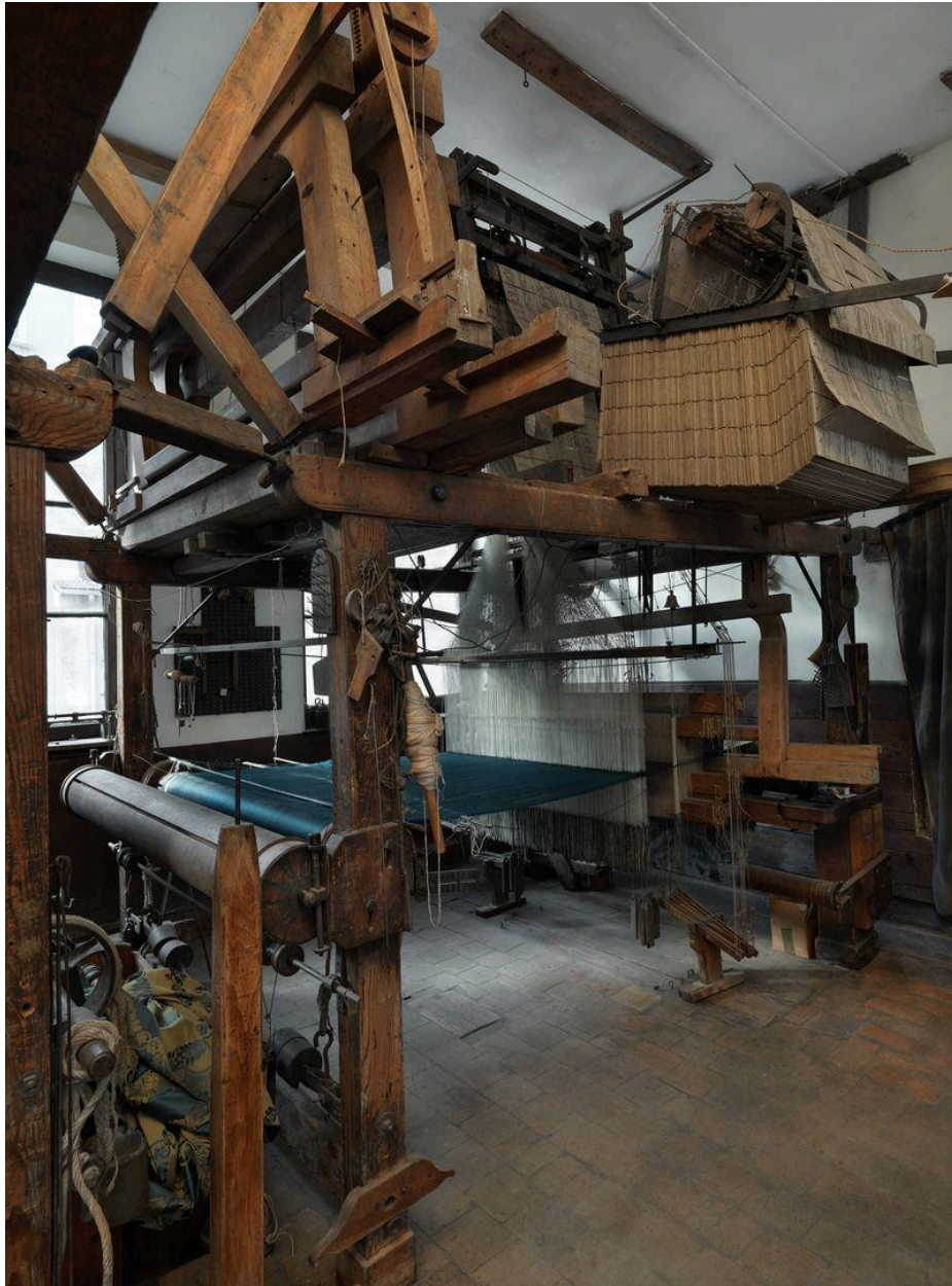
Vue des mécaniques jacquard : métier grande largeur (140cm x 180 cm) dit "Grand métier" Damas sous envers
