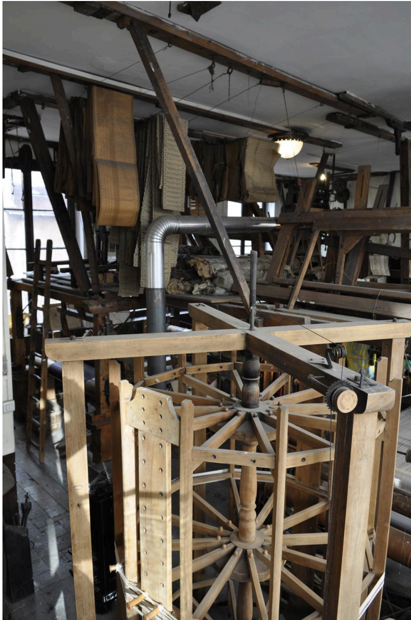
Ourdissoir de 1830 en noyer de l'atelier de tissage à bras de Georges Mattelon
