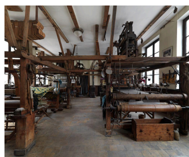
Vue d'ensemble des quatre métiers à tisser à bras classés MH, 1er plan droite métier pour nouveauté (90cm), métier de gauche grand métier grande largeur (140cm) Phot. Thierry Leroy IVR84_20166901263NUCAQ
