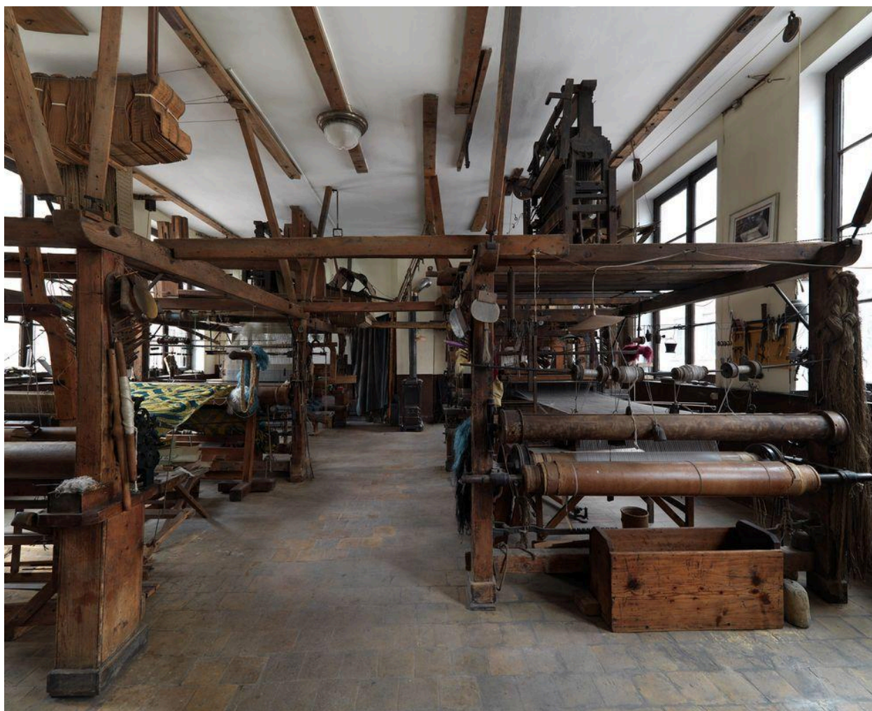
Vue d'ensemble des quatre métiers à tisser à bras classés MH, 1er plan droite métier pour nouveauté (90cm), métier de gauche grand métier grande largeur (140cm)
