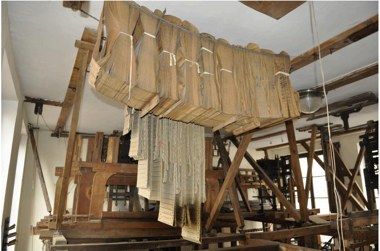
Cartons perforés de la mécanique jacquard : Atelier de tissage à bras de Georges Mattelon en 2016
