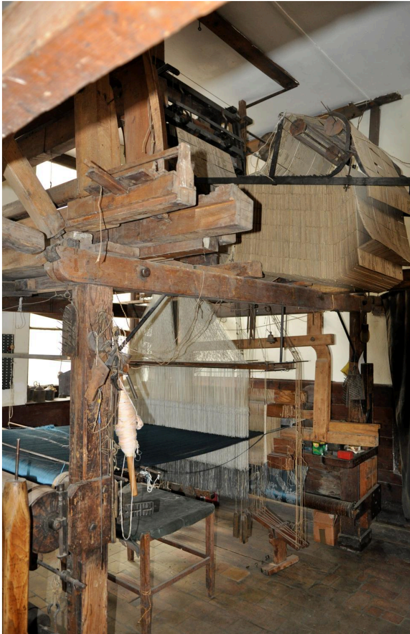
Métier grande largeur (140cm x 180 cm) dit "Grand métier" Damas sous envers : atelier de tissage à bras de Georges Mattelon en 2016
