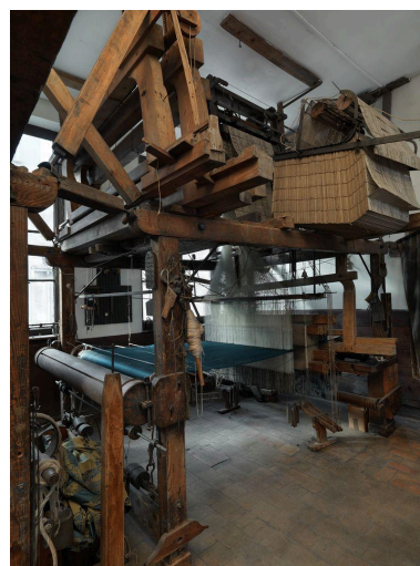
Vue des mécaniques jacquard : métier grande largeur (140cm x 180 cm) dit "Grand métier" Damas sous envers Phot. Thierry Leroy IVR84_20166901252NUCAQ
