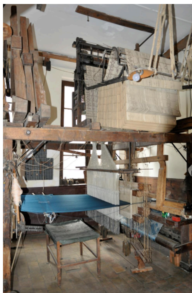
Métier grande largeur (140cm x 180 cm) dit "Grand métier" Damas sous envers : atelier de tissage à bras de Georges Mattelon en 2016 Phot. Nadine Halitim-Dubois IVR84_20166900061NUCA
