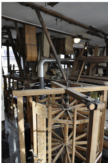
Ourdissoir de 1830 en noyer de l'atelier de tissage à bras de Georges Mattelon Phot. Nadine Halitim-Dubois IVR82_20116900046NUCA
