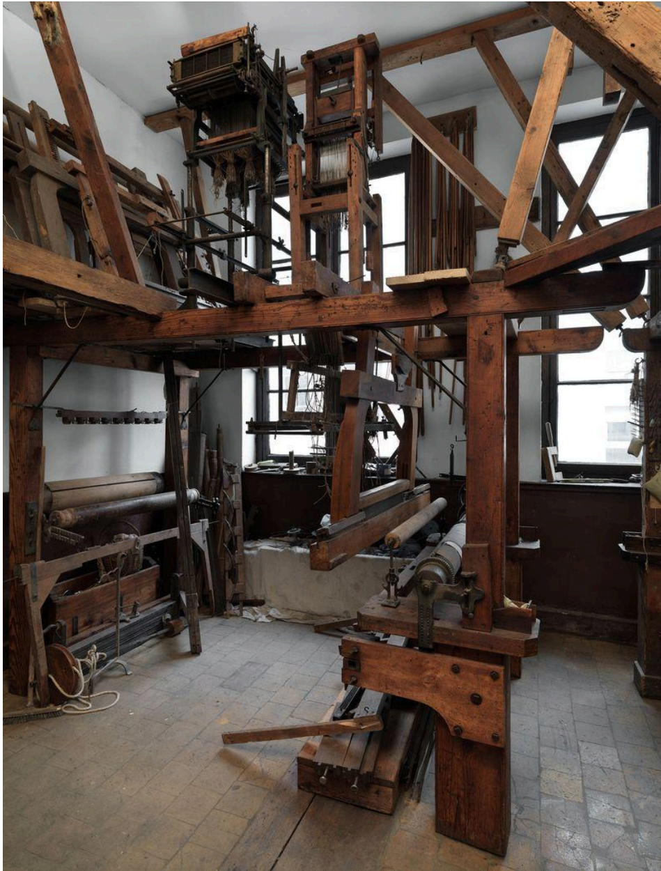
Métier à bras pour nouveauté petite largeur (54cm x 70cm) en cours de montage
