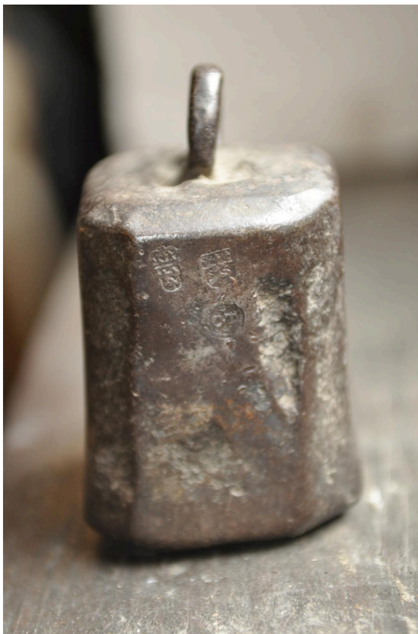
Détail poids avec marquage de poids et poinçon : matériel de l'atelier de tissage à bras de Georges Mattelon
