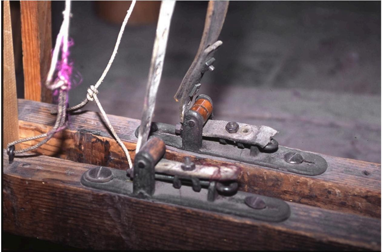
Système du marcheur qui va permettre de mettre les 2 courroies à la même tension
