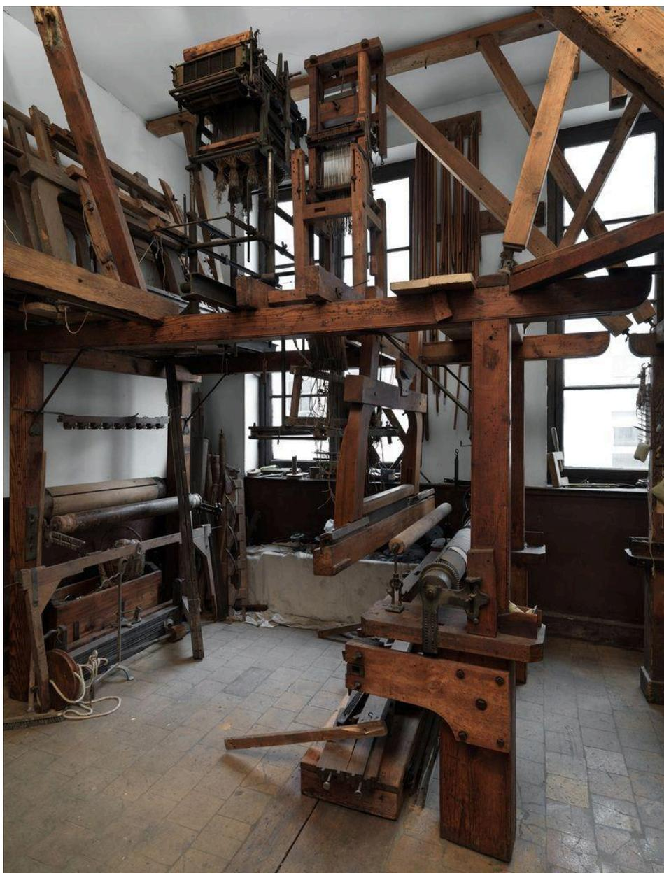
Détail métier à tisser à bras et partie haute mécanique
