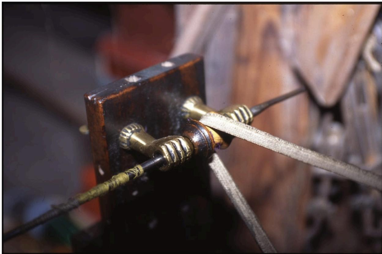
Maintien de la courroie d'entraînement par les deux mains du rouet (passant en forme de mains)
