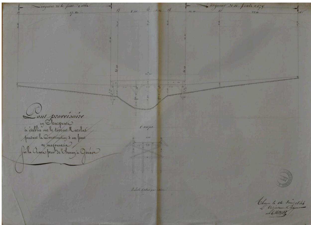
Plan provisoire en charpente à établir sur le torrent de Marclaz pendant la construction d'un pont en maçonnerie. 14 juin 1844 (AD Haute-Savoie. 10 FS 51)
